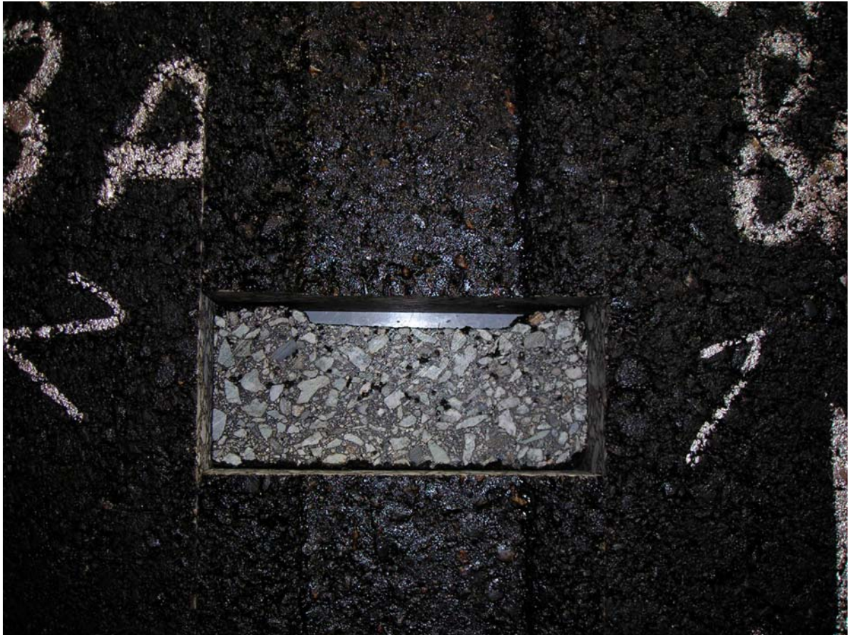
Figur 8 Ab 8 etter testing i wheel-track
