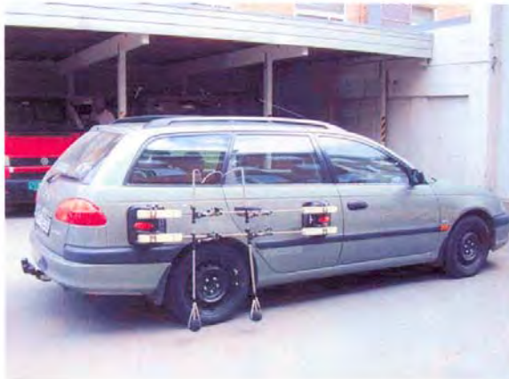
Figur 1. Mikrofonplassering og bil for CPX-måling
