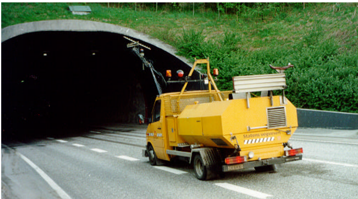
Figur 13. Bil som påfører såpe ved tunnelvask.
