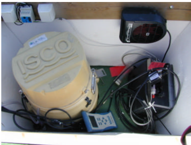
Figur 7. Utstyr plassert ved innløp og utløp til behandlingsanlegg for tunnelvask ved Vassum i mai/juni 2000; Hydrolab-sonde, ISCO ekkolodd-logger og ISCO autom. vannprøvetaker.
