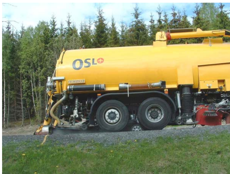
Figur 30 Rensemaskin Frimokar, som høytrykksspyler vegdekket og suger opp vaskevannet [4]
