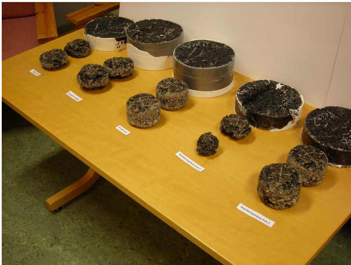
Figur 27 Prøvestykker etter testing av Cantabro og wheel-track for alle massetyper (fra venstre Da 11 ref, ViaQ11/ViaQ16, Da8/Da16, DaFib8/DaFib16 felt 1, DaFib8/DaFib16 felt 2) – Bjørkelangen [6]
