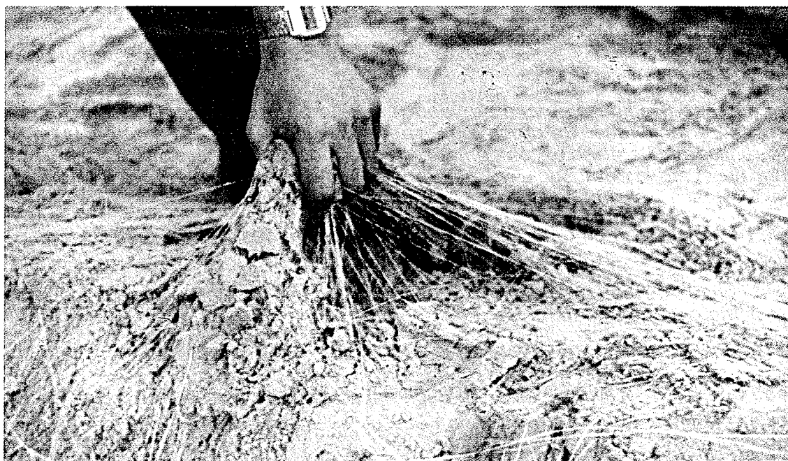
Fig. 8. Texsol-sand med tekstilfiber
