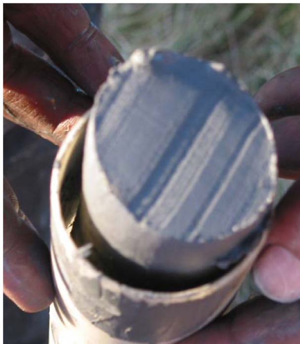
Fig. 10 Strekk i prøven på mer enn 2 x diameteren
