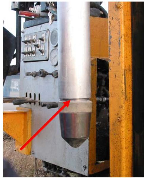
Fig. 6 Skjæreggen ikke skrudd helt inn
