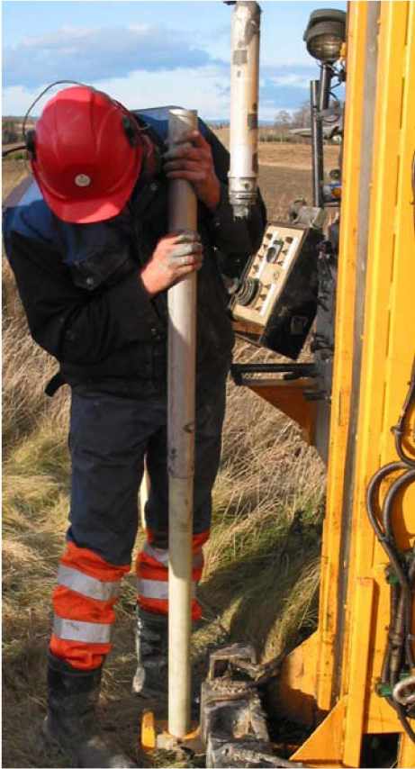
Fig. 7 Sylindren satt fast i dekkerøret
