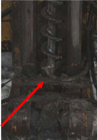
Fig. 21 Modifisert skovl med flat og skarp spiss til forboring ned til bestemt nivå
