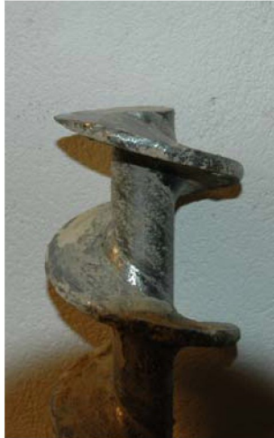
Fig. 21 Modifisert skovl med flat og skarp spiss til forboring ned til bestemt nivå
