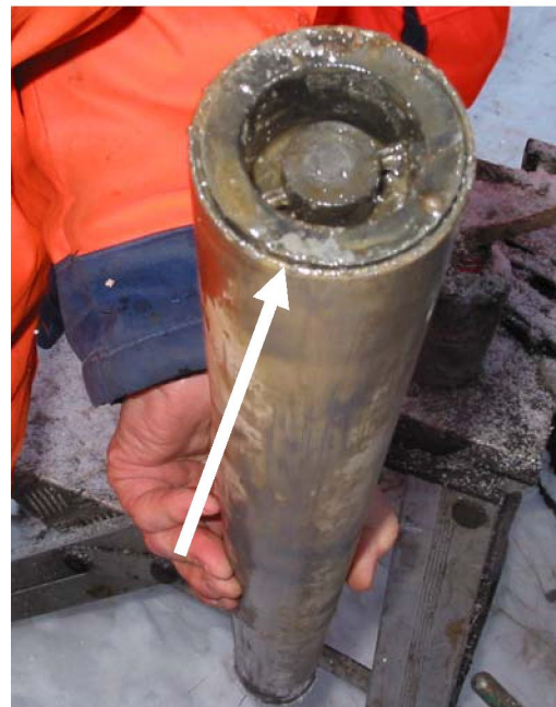
Fig. 14 Stempel trukket ut av sylindere under frigjøring
