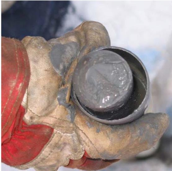
Fig. 19 Største strekk i prøven på mer enn 2 x diameter som er registrert
