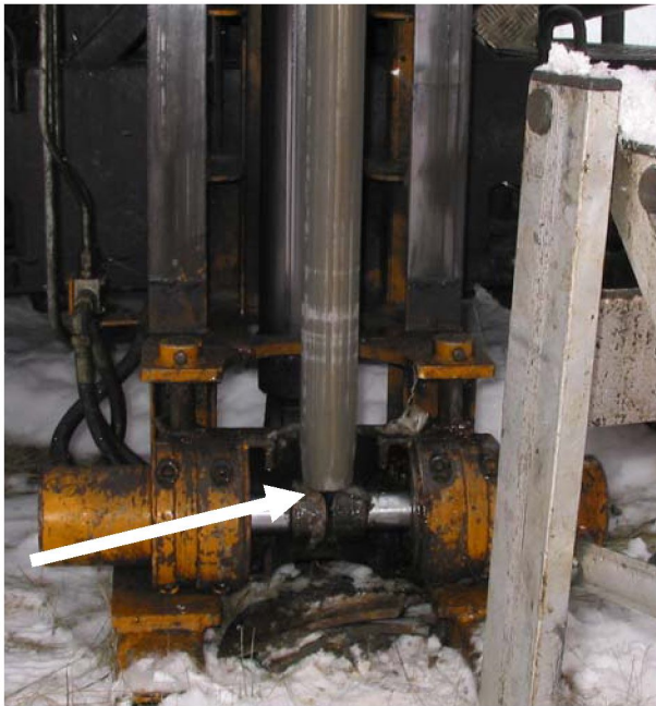
Fig. 13 Prøvetaker med slank egg "hviler" på bunnklemmens bakker
