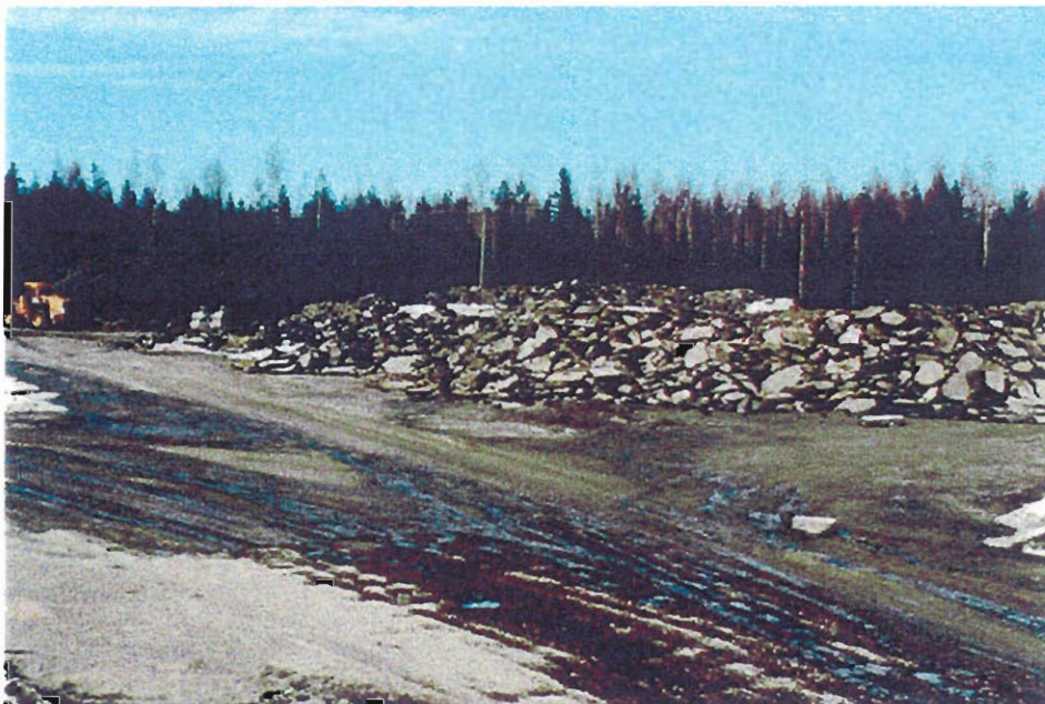
Foto 1. Upplagsplatsen vid Överskog i maj 1998. I förgrunden till höger upplags- hög med uppbrutna asfaltmassor (flak), i bakgrunden upplagshög med asfaltgranulat.
