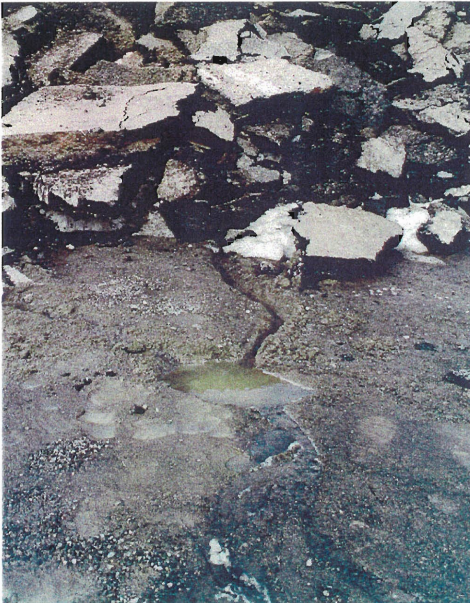
Foto 5. Grop för provtagning på "lakvatten" från upplagshög med uppbruten asfalt massa.
