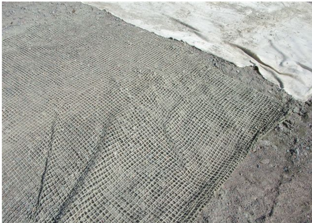
Figur 19: Prøvestykker av armeringen
