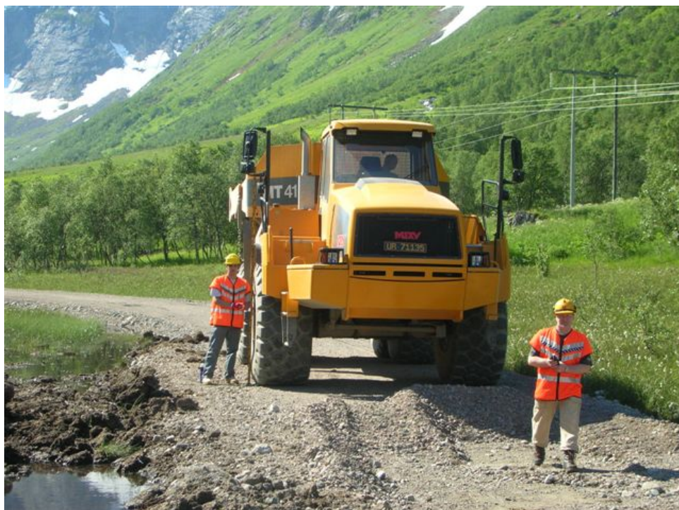
Figur 20: Måling av nedsynkning ved lastprøving.
