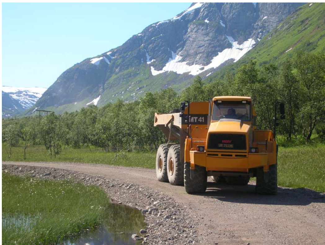
Figur 6: Prøvebelastning med dumper, ca 70 tonn
