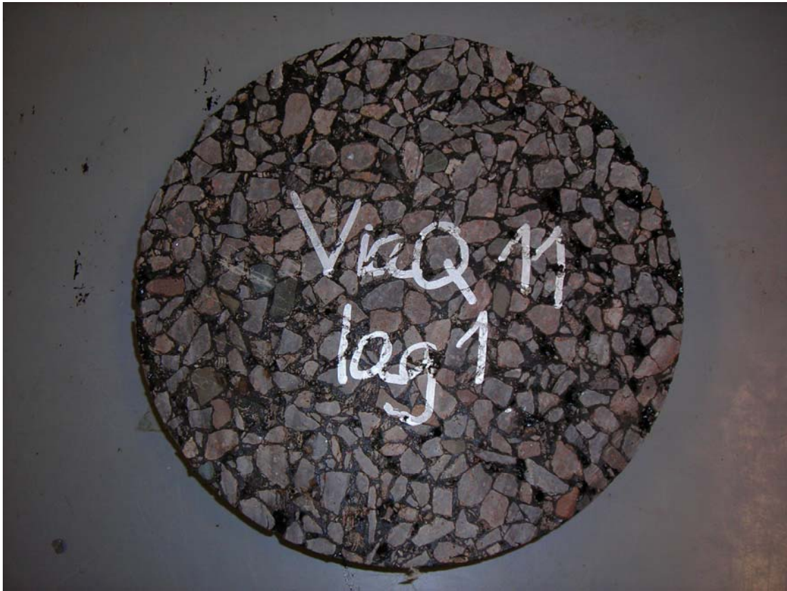
Figur 7 Overflate etter saging for ViaQ 11
