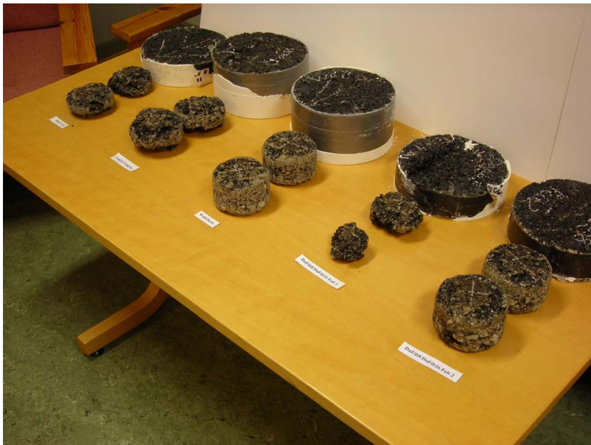
Figur 27 Prøvestykker etter testing av Cantabro og wheel-track for alle massetyper (fra venstre Da 11 ref, ViaQ11/ViaQ16, Da8/Da16, DaFib8/DaFib16 felt 1, DaFib8/DaFib16 felt 2)
