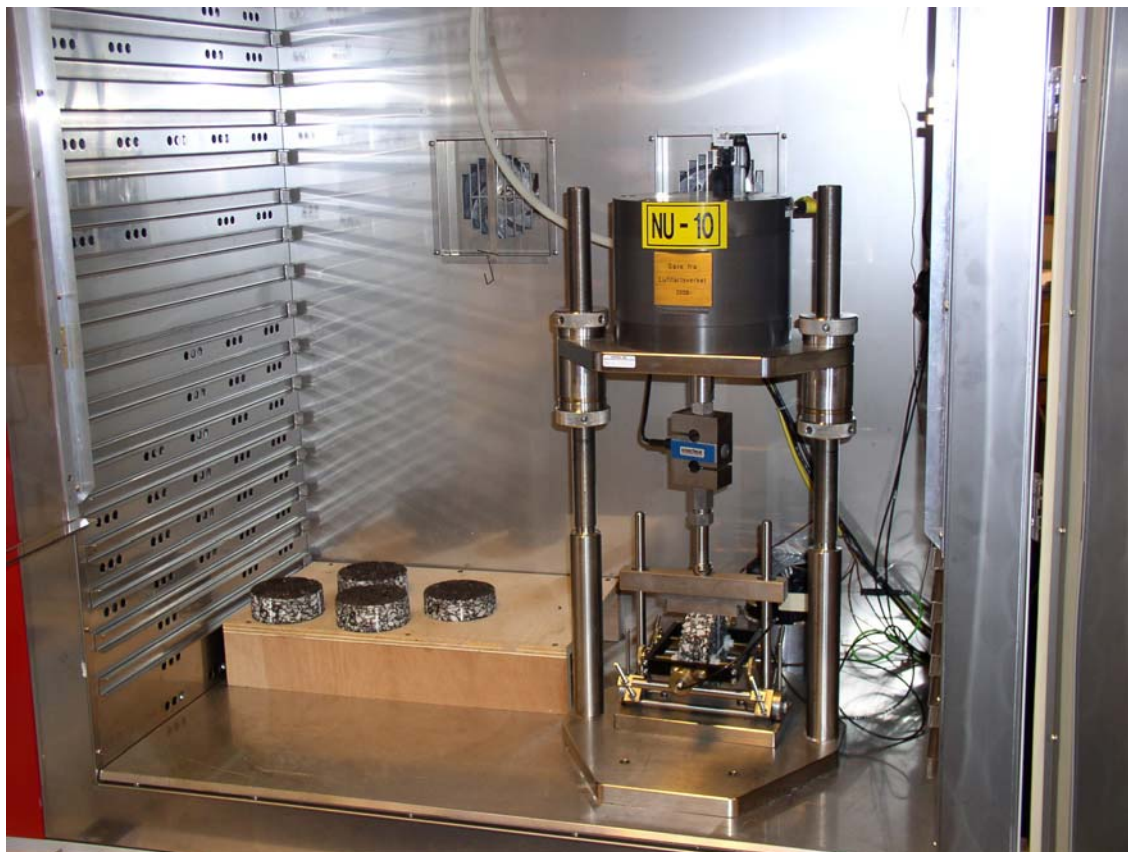
Figur 15 Bestemmelse av E-modul i Nottingham Asphalt Tester (NAT)
