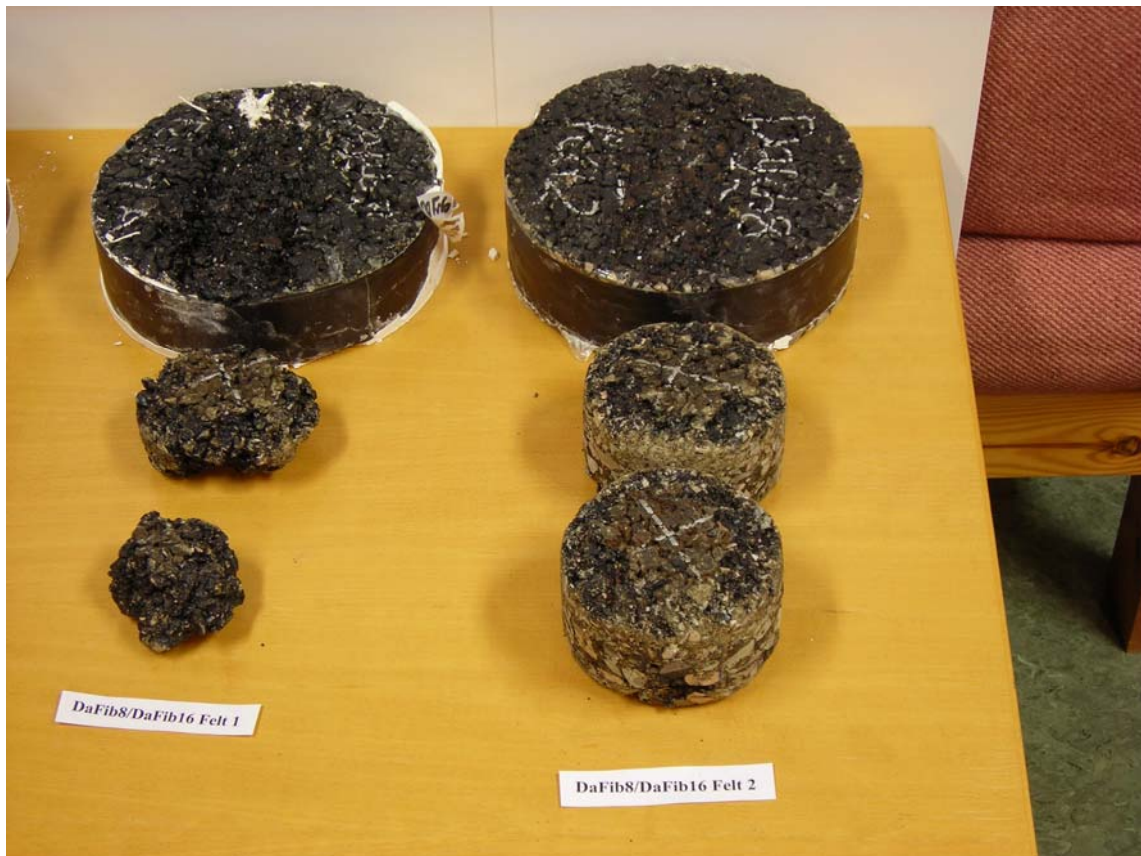
Figur 30 Prøvestykker etter testing av Cantabro og wheel-track for DaFib8/DaFib16 felt 1 og DaFib8/DaFib16 felt 2
