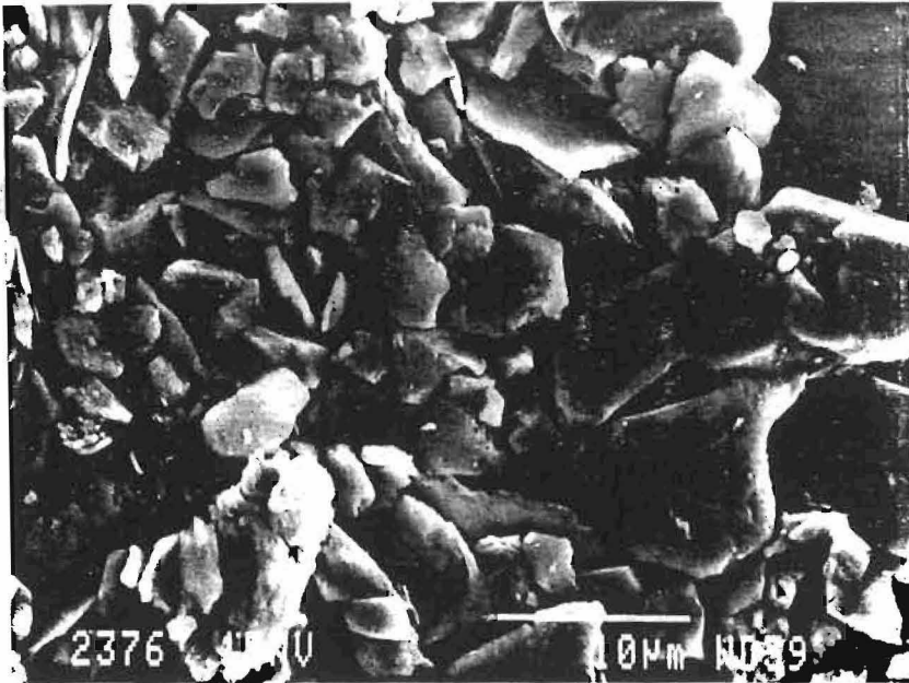
Sveipe-elektronmikroskopfoto og skisse for karbonbelagt siltprøve (0,002-0,020 mm) fra Hjera
