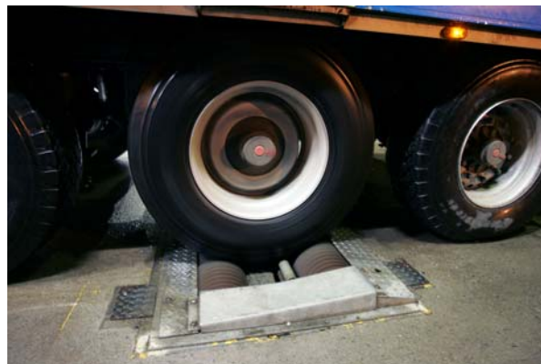
Bremseprøveapparat. Her måles bremseeffekt og eventuelle skjevheter mellom høyre og venstre side. Alle aksler sjekkes, og den totale bremseeffekten vurderes opp mot gjeldende krav i kontrollveiledningen.
