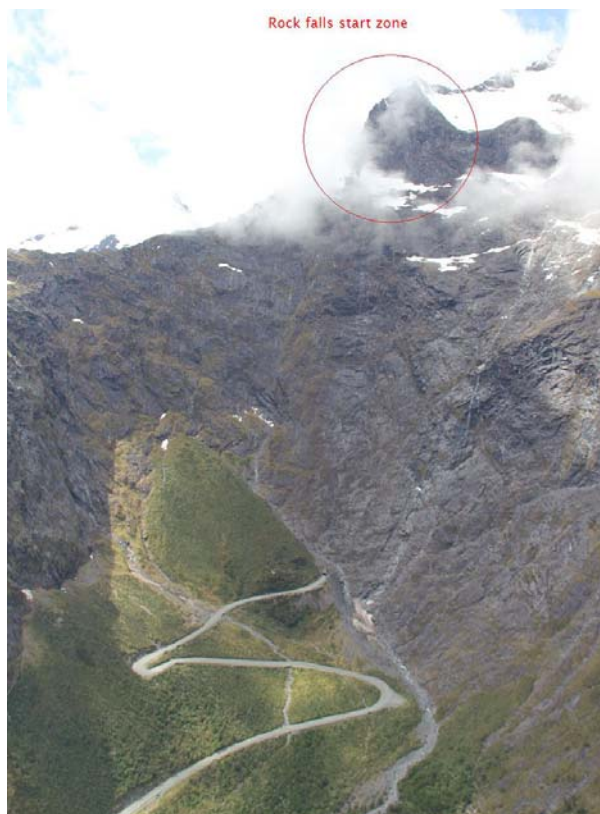
Figur 13 og 14: Steinsprang fra 1700moh mot Homertunnel på 900moh (fig 9). Gjenværende ustabil blokk på ca. 2000 tonn i løsnemrådet (fig 10).
