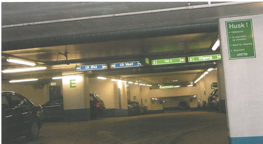
Belysningen markerer grensen mellom kjørebane og p-plasser. Bemerkt skiltingen som ved bruk av fargekoder henvender seg både til kjørende (blå) og til gående (grønn).
