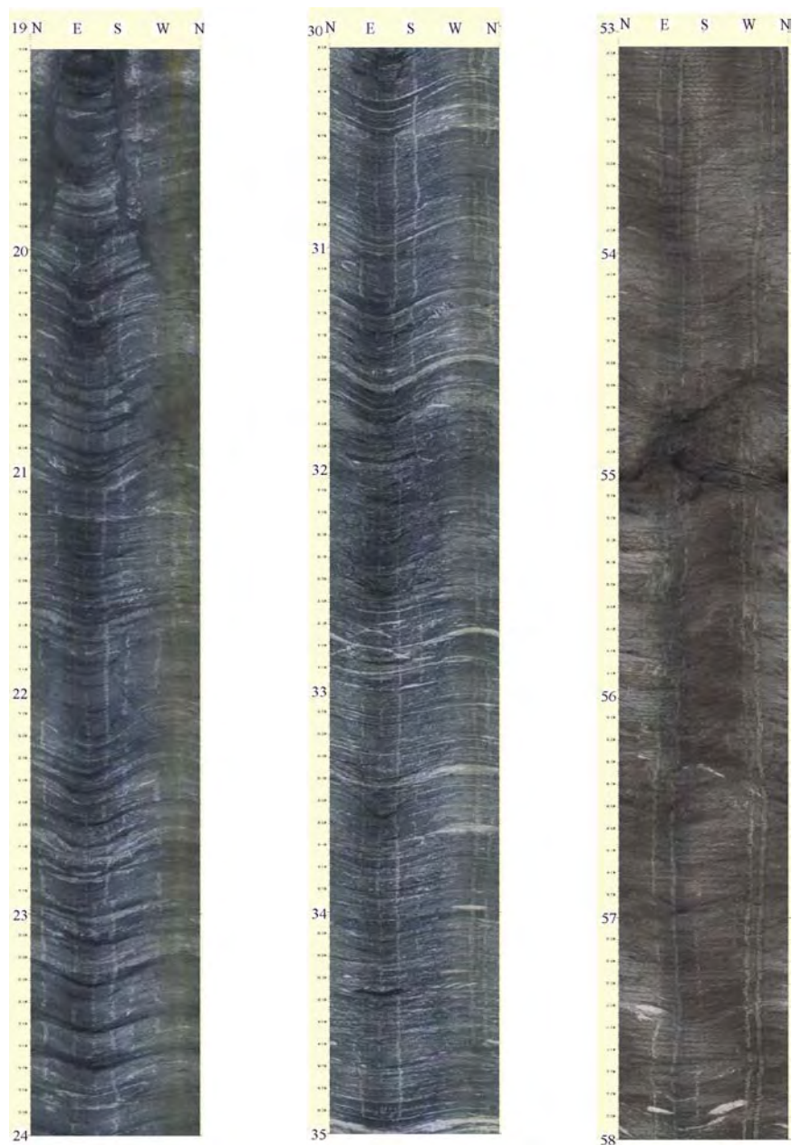
Figur 34. Bh B1, Brekka. OPTV logg av utvalgte deler av borehullet som viser foliasjonssprekker (venstre), lagdelt bergart (midten) og parti med noe dårlig fjell (høyre).
