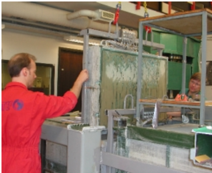
Bilde 2 Glassplate løftes ut etter gjennomført forsøk.
