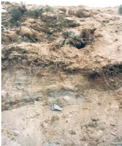
Fig. 11: Foto som viser ur over eldre avsetninger av lagdelt grus og sand. Under marin grense kan underlaget være marin leire. Rv. 37 Tinnsjøvegen, Telemark.
