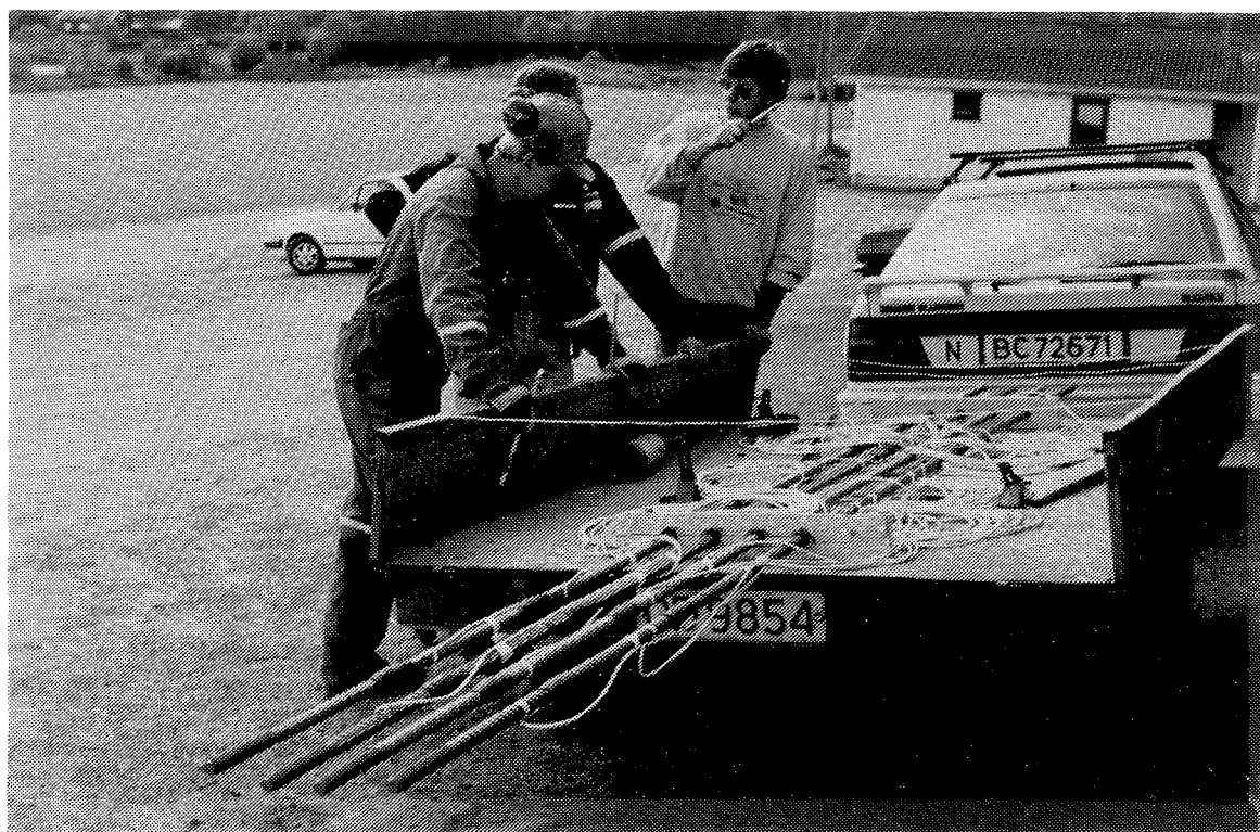
Bilde 12 4 instrumenterte jordnagler med totalt 40 strekkklapper.
