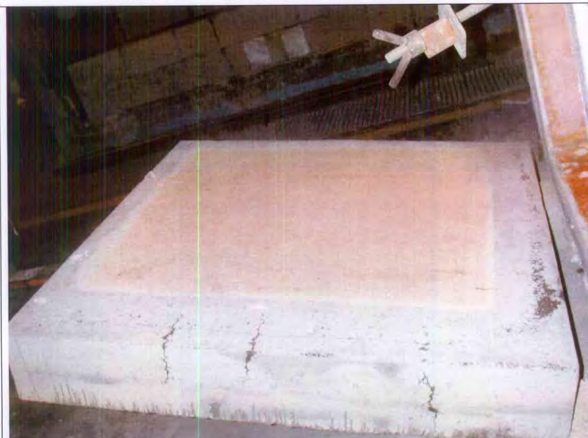
Foto 4: Eksponert side av prøvestykke B etter brann testen.
