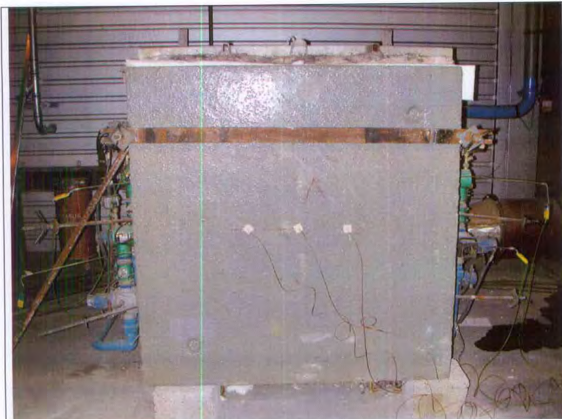
Foto 1: Ueksponert side av prøvestykke A etter branntesten.
