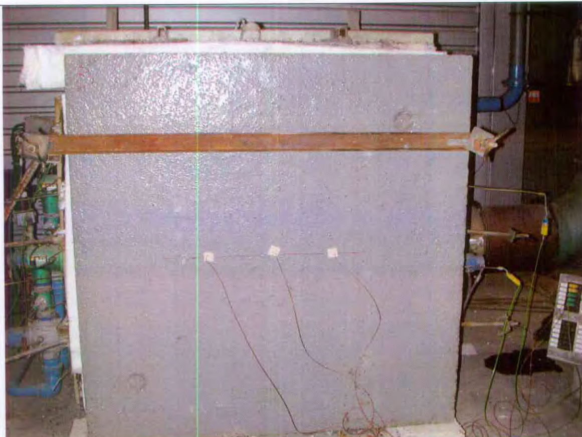
Foto 3: Ueksponert side av prøvestykke B etter brann testen.
