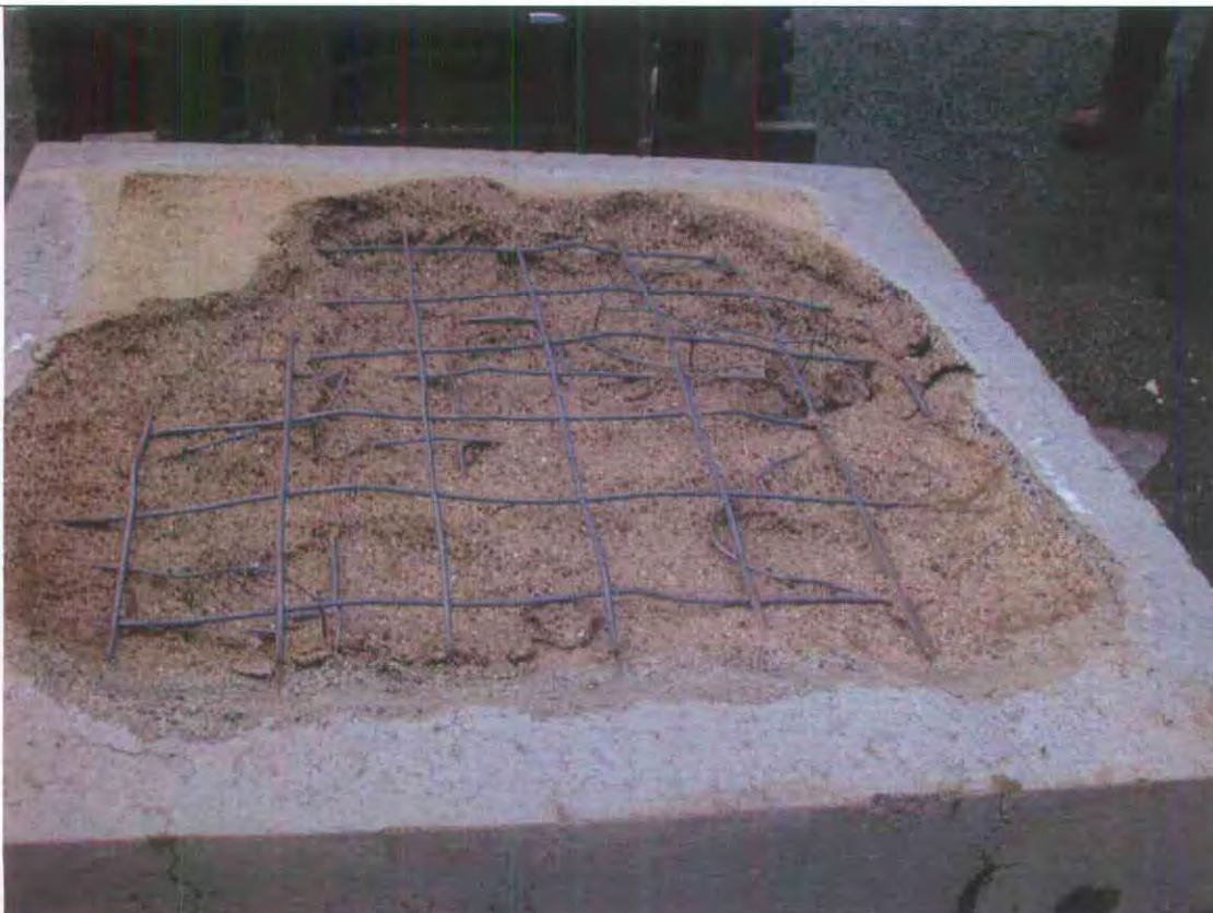
Foto 2: Eksponert side av prøvestykke D etter brann testen.
