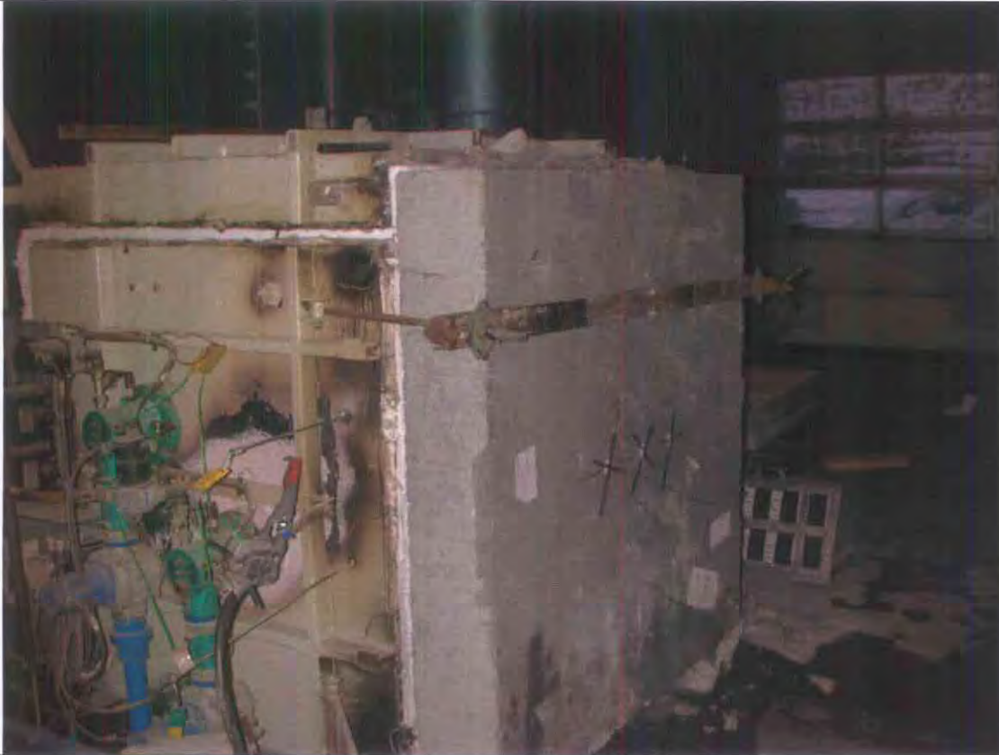
Foto 1: Eksponert side av prøvestykke D etter brann testen.
