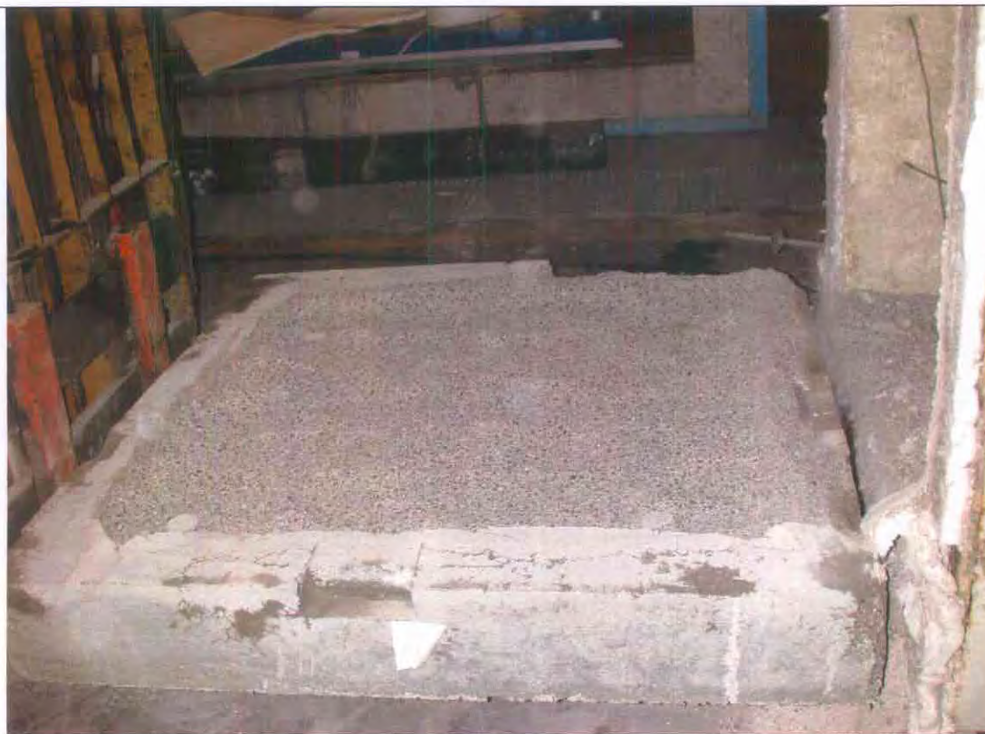
Foto 4: Eksponert side av prøvestykke E etter branntesten.
