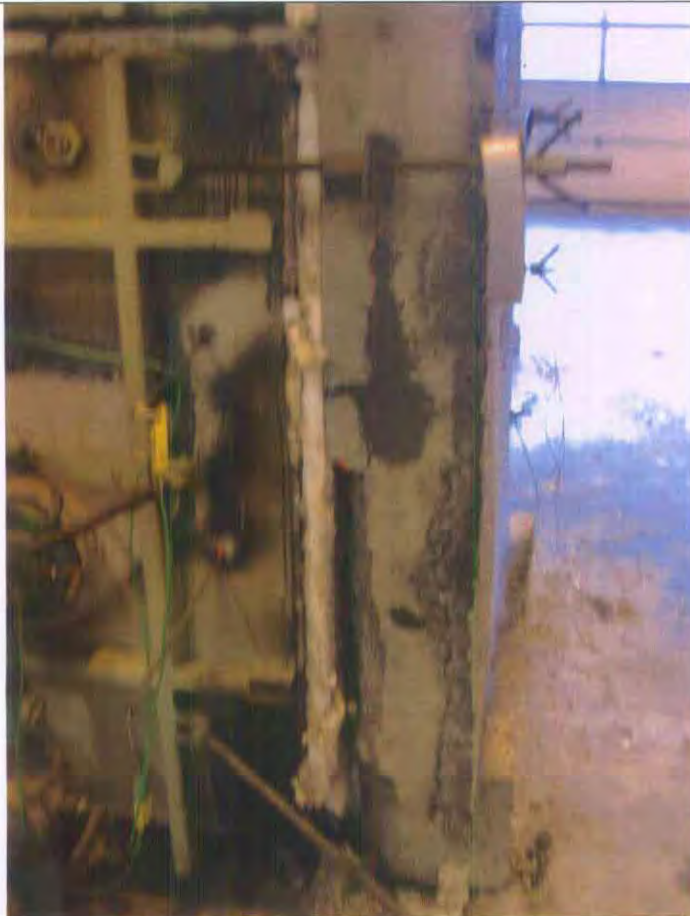
Foto 3: Ueksponert side av prøvestykke E etter branntesten.
