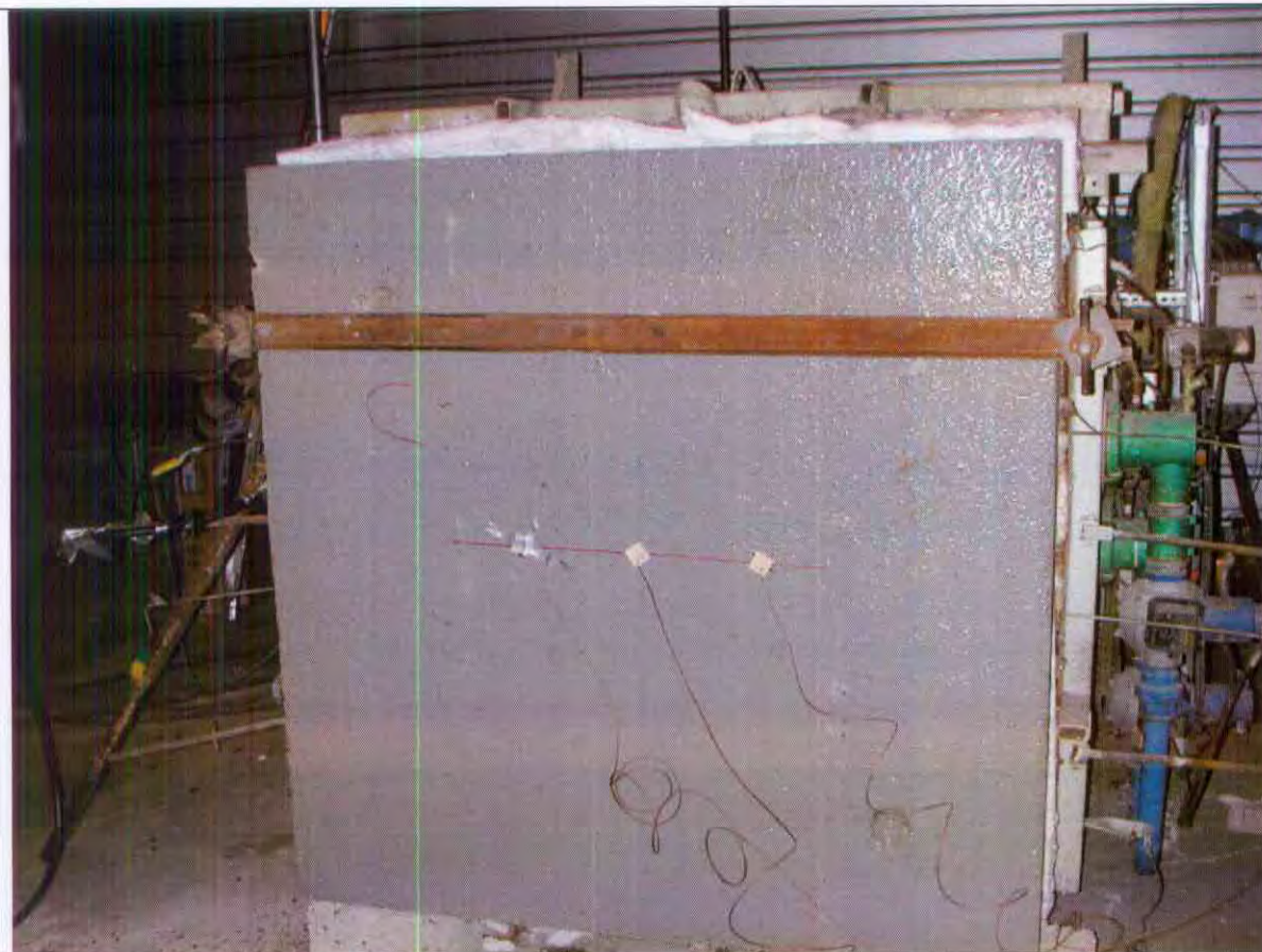
Foto 5: Ueksponert side av prøvestykke C etter brann testen.
