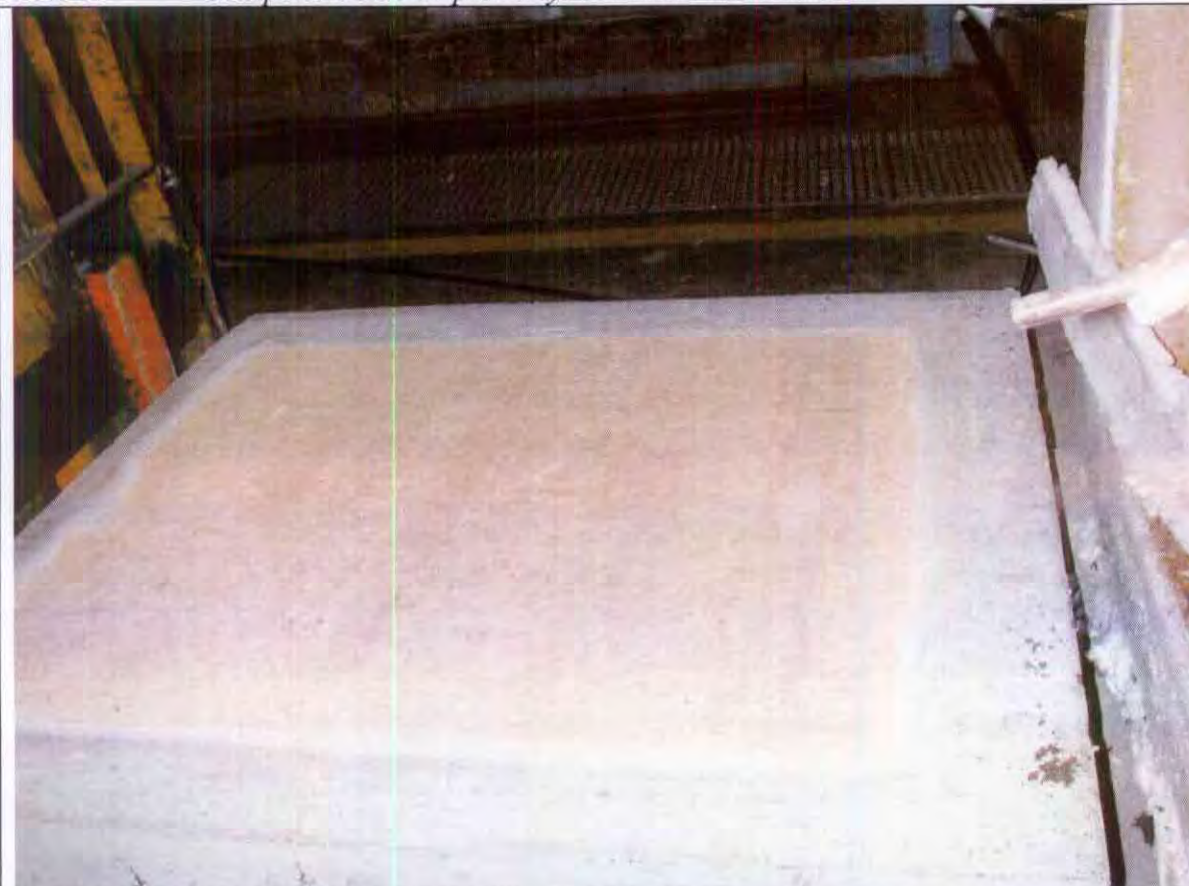
Foto 6: Eksponert side av prøvestykke C etter brann testen.
