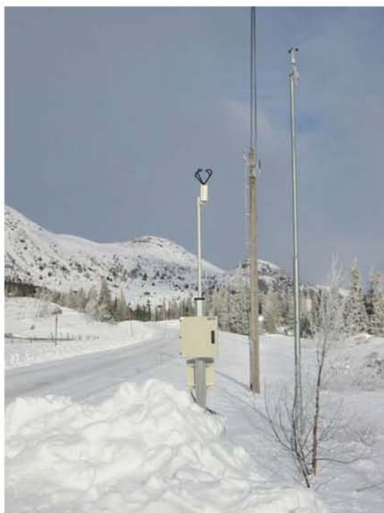
Figur 18: Eksempel på en klimastasjon
