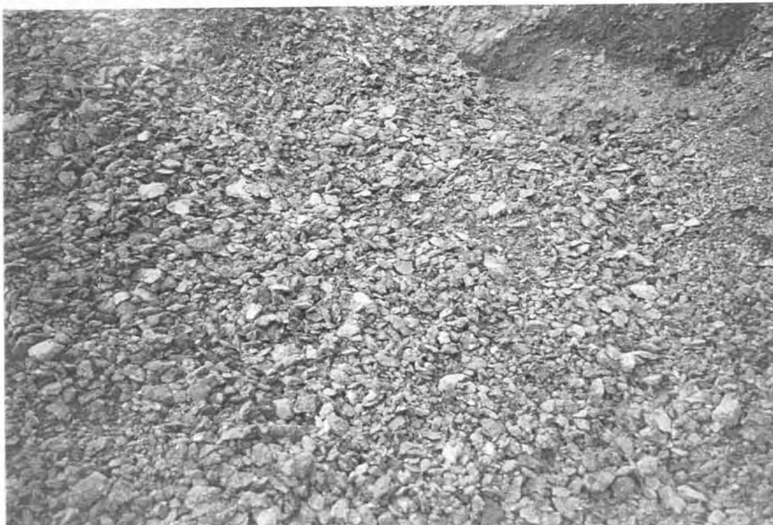
FIGUR 18 Fresemasse fra Fv 78 før knusing
