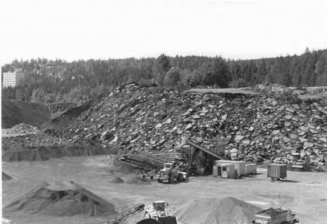
FIGUR 41 OVV's knuseverk i gang med sikting av fresemasser (innkjørte lagerhauger til venstre på bildet). Bak verket ruver det store deponiet av flakmasser.
