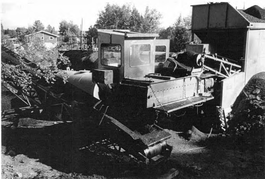
FIGUR 19 SVV Buskeruds ombygde oljegrusverk brukt til produksjon av Gja i Drøbak
