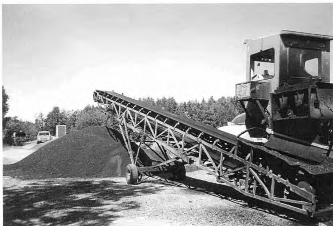
FIGUR 29 Transportbånd til sideplassert lagerhaug (gir bedre plass for opplastingen)
