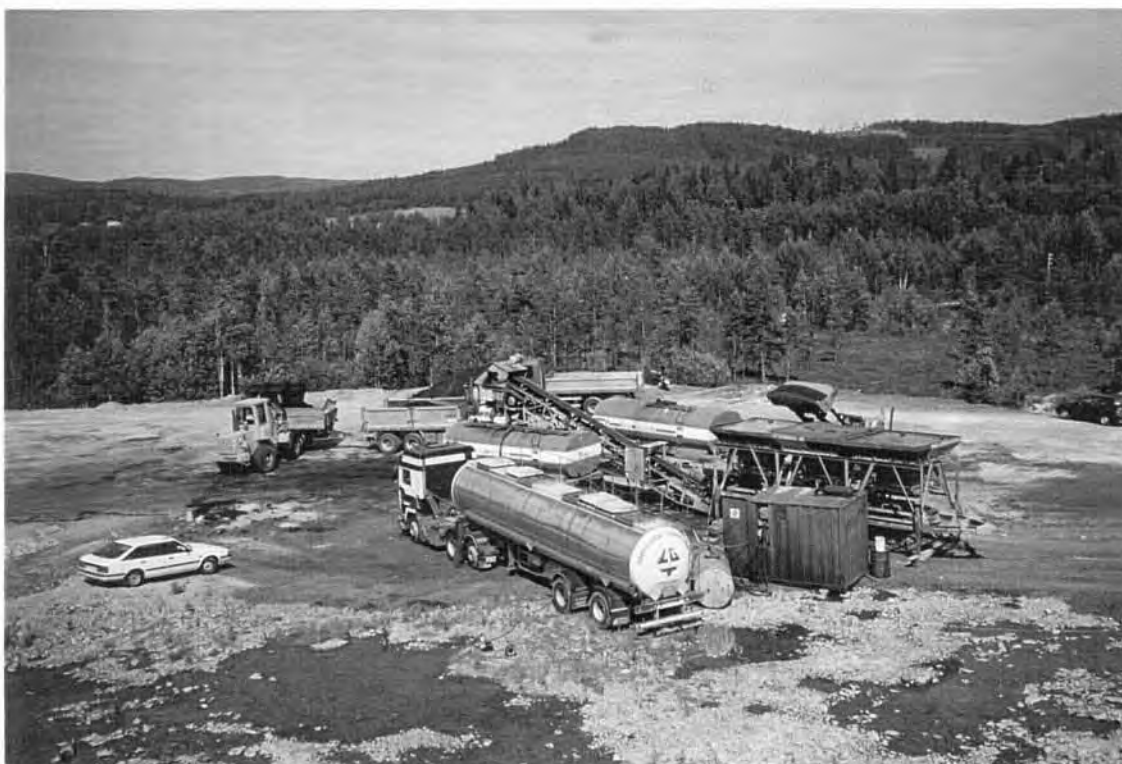
FIGUR 5 Base Mixer blandeverk, Gja-produksjon for Rv 200, Hedmark
