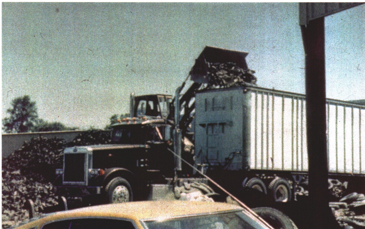
Figur 11. Opplasting av dekkbiter for transport
