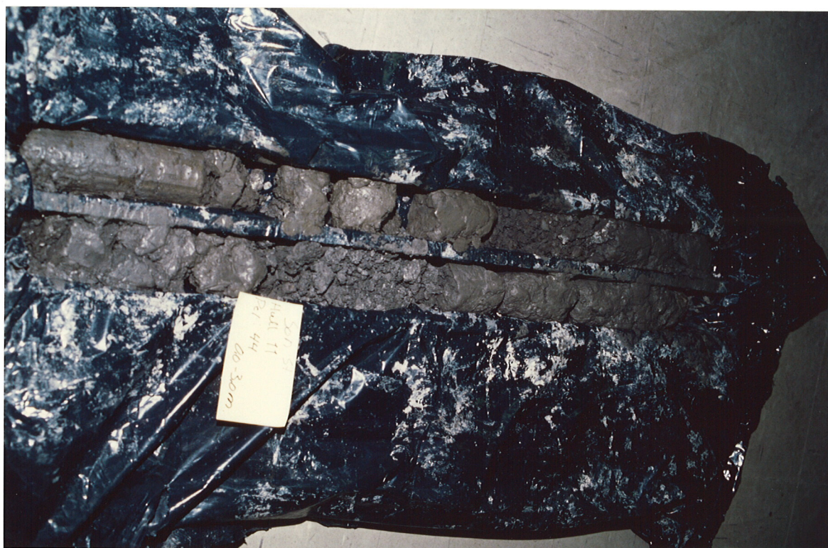
Bilde 4: Hull nr. 11, pel 44, dybde 0.0 - 3.0 m, kalkstabilisert leire
