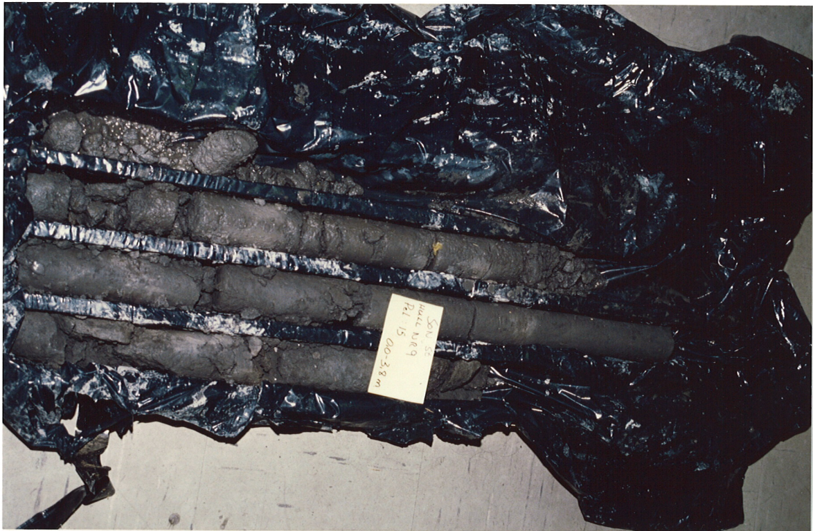
Bilde 1: Hull nr. 9, pel 15, dybde 0.0 - 3.8 m, kalk-/sementstabilisert leire
