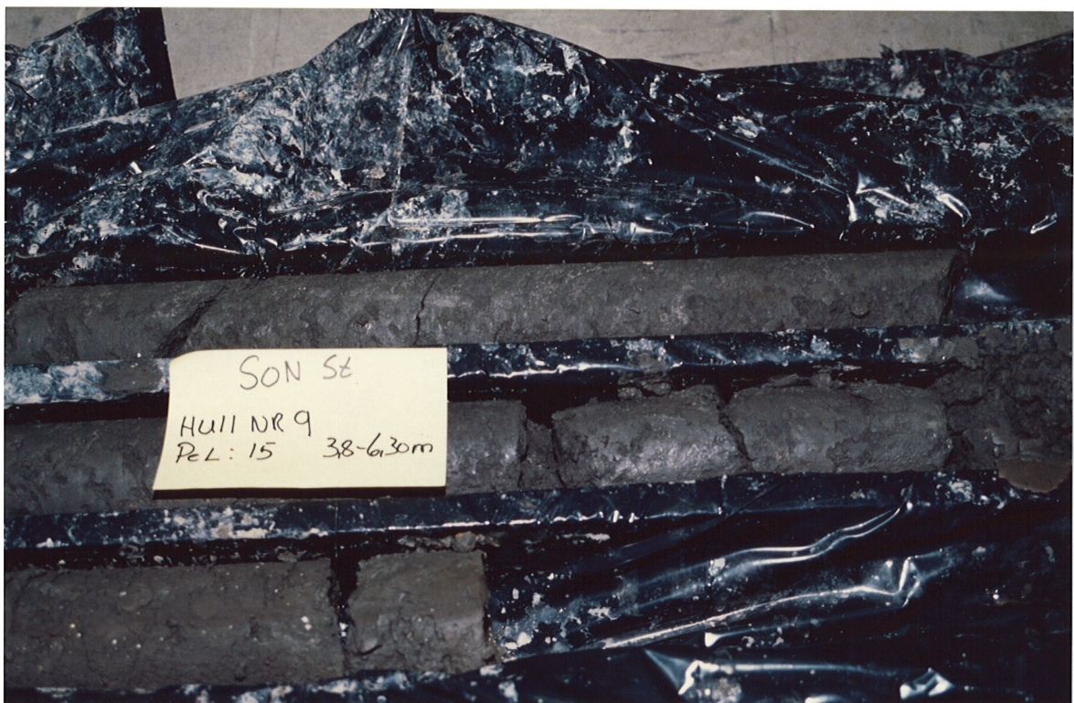
Bilde 2: Hull nr. 9, pel 15, dybde 3.8 - 6.3 m, kalk-/sementstabilisert leire
