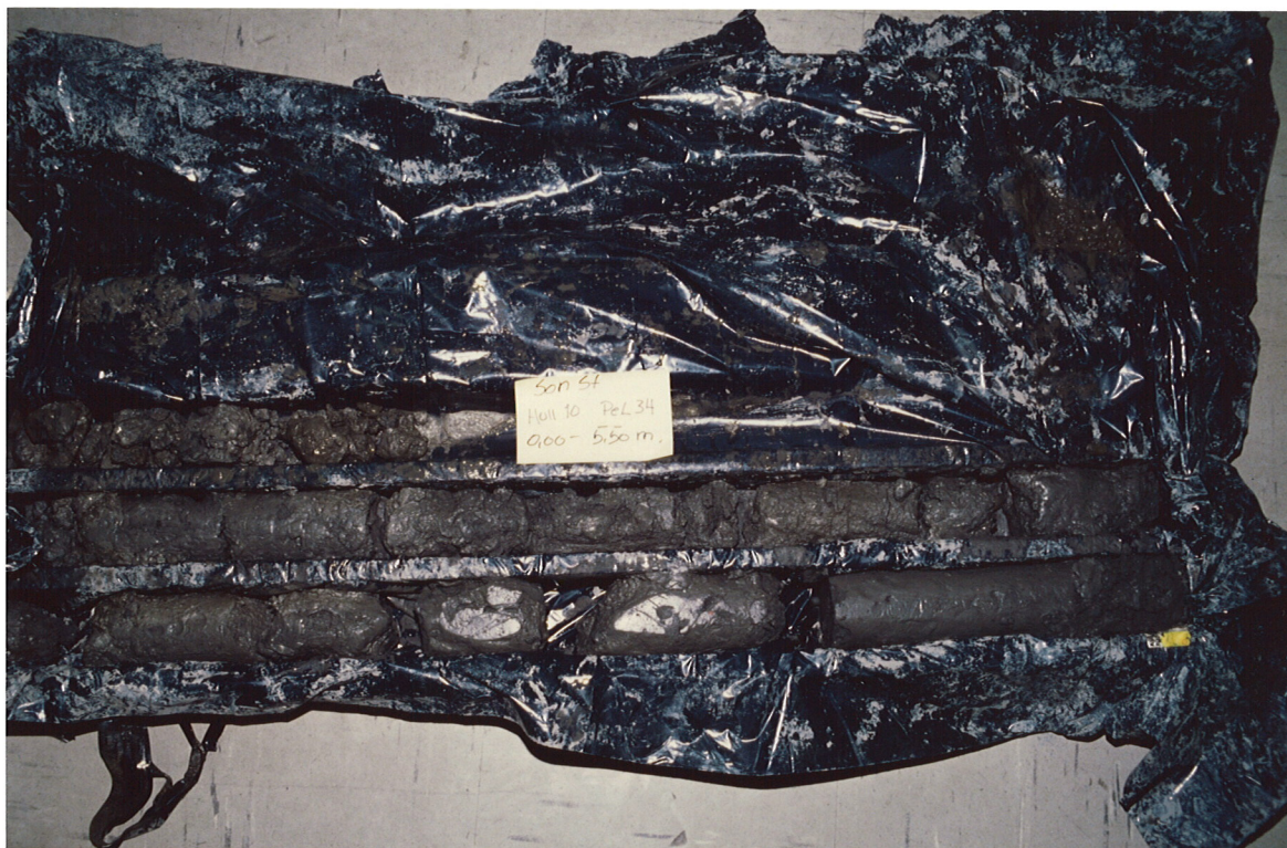
Bilde 3: Hull nr. 10, pel 34, dybde 0.0 - 5.5 m, sementstabilisert leire
