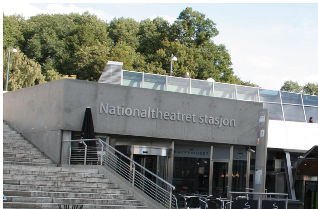
Skilt og fasade går i ett. Mangel på kontrast gjør det vanskelig å lese stasjonsnavnet.
