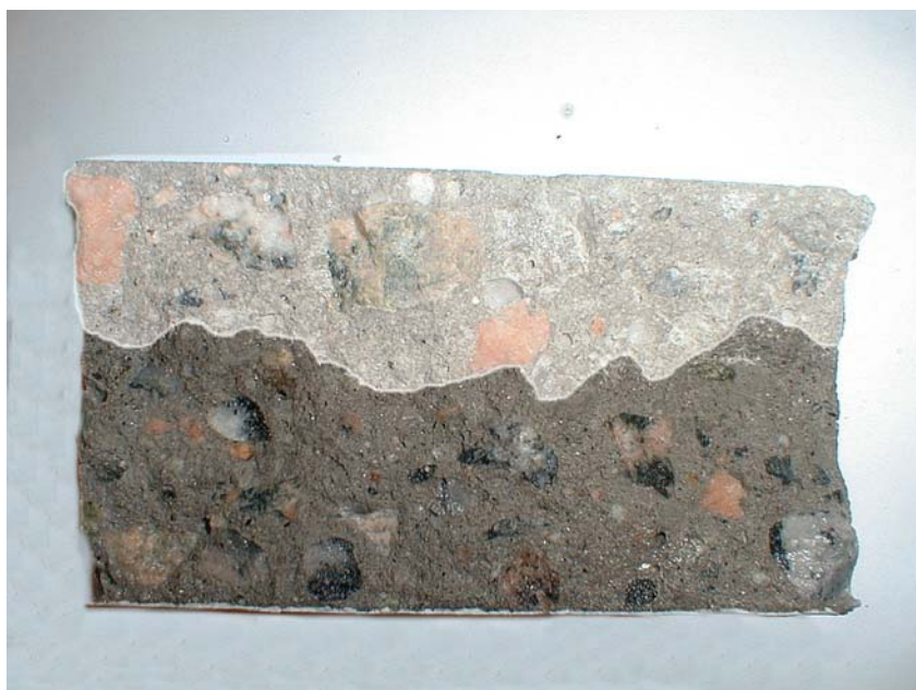
Bildet viser inntrengning av silangel (hydrofobering) med inntrengningsdybde ca 20 mm
