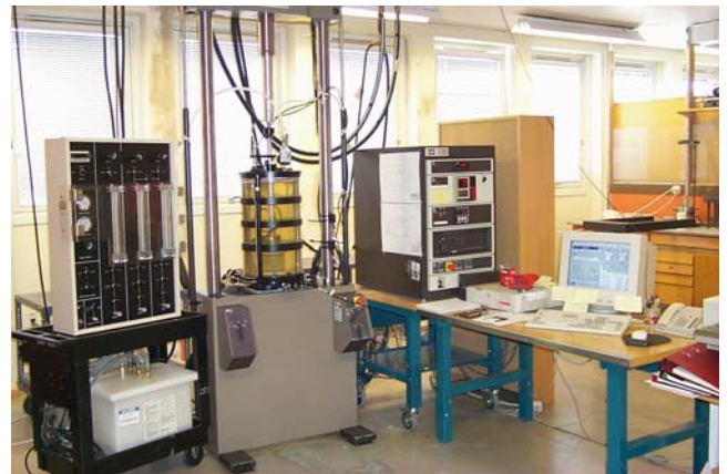
MTS testrigg for treaks-bestemmelse av E-modul på asfaltprøver.
