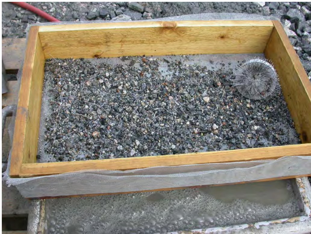
Figur 3: Betongprøven ferdig utvasket og stålfiber trukket ut
