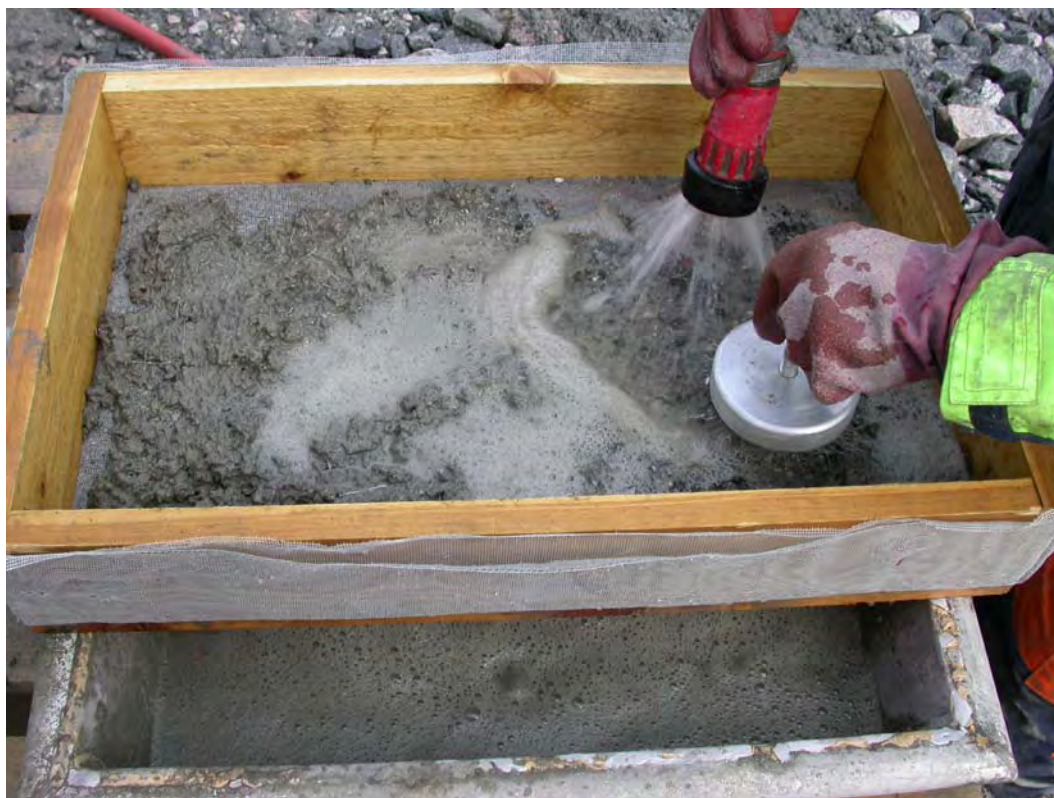
Figur 2: Utvasking av hver enkelt prøve og uttrekking av stålfiber ved hjelp av magnet
