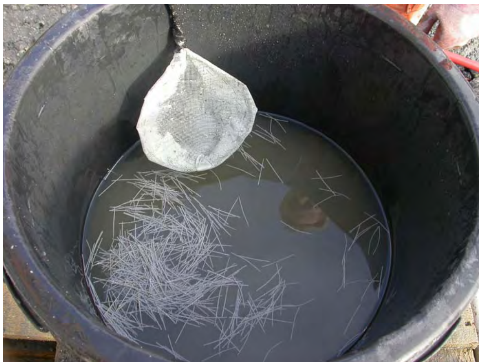
Figur 4: Betongprøven ferdig vasket ut og plastfiberen flyter opp
