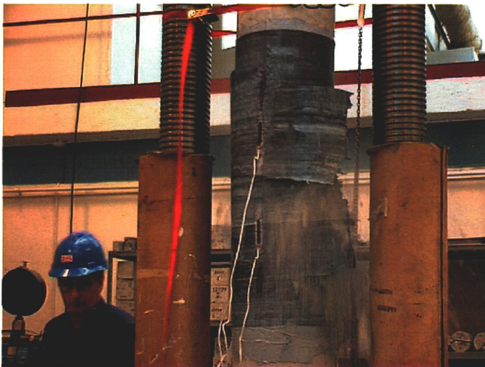
Fig B-1 Eksplosivt brudd i søyle S3
