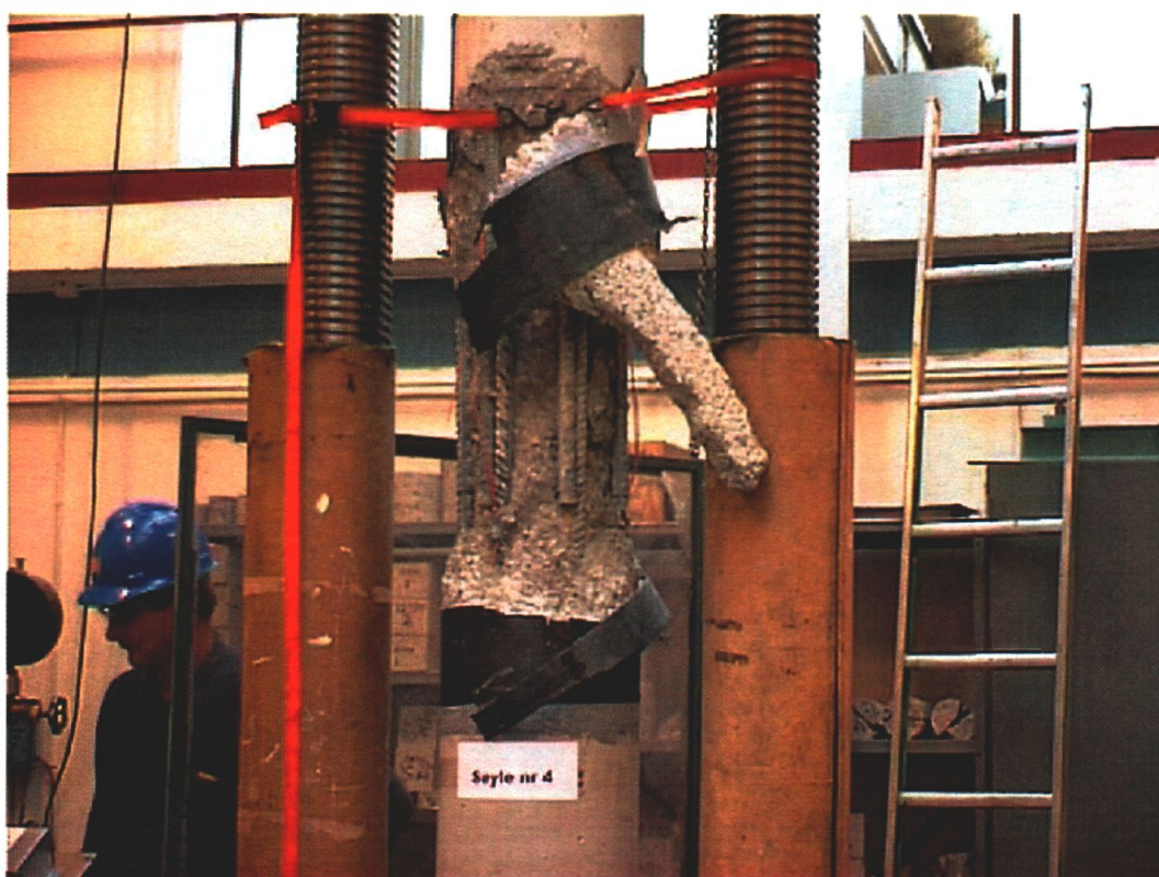
Fig 11 Søyle S4 med to lag karbonfiberrev etter brudd
