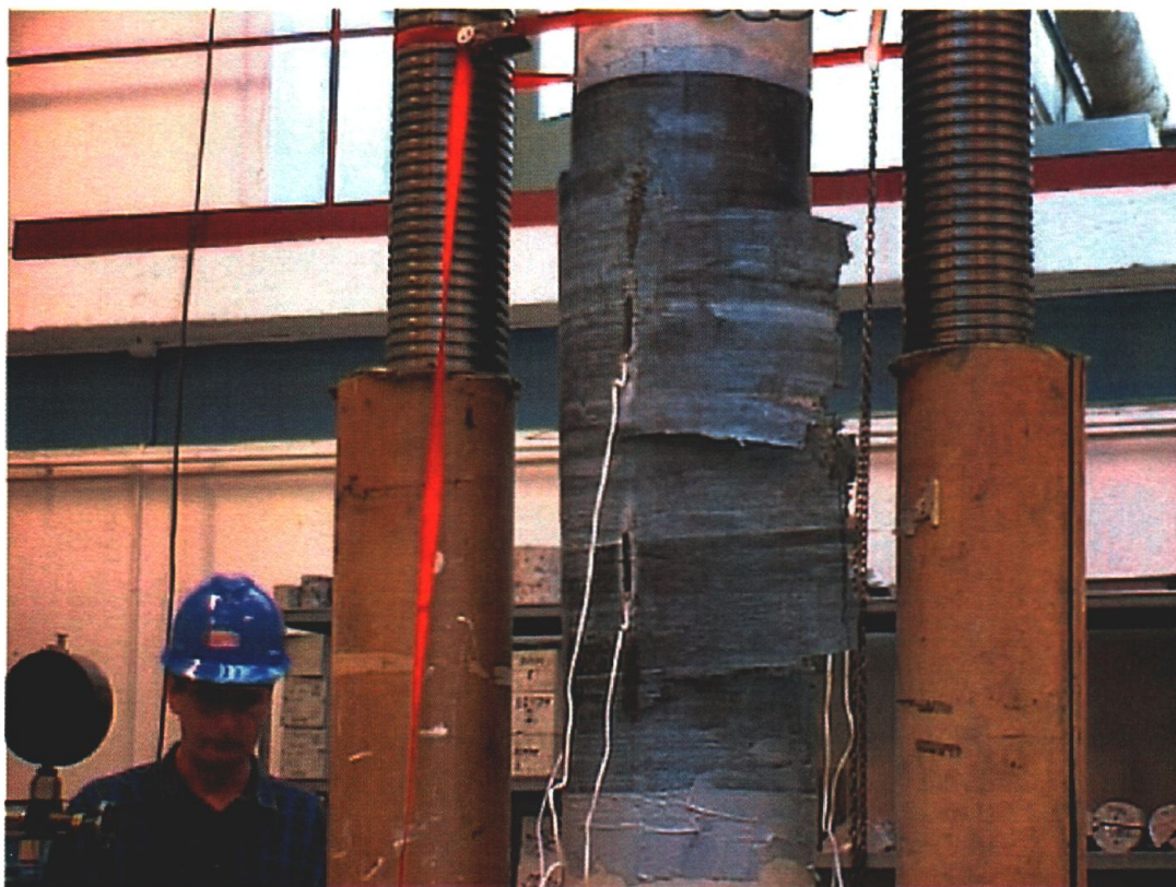
Fig 10 Søyle S3 med ett lag karbonfiberrev etter brudd
