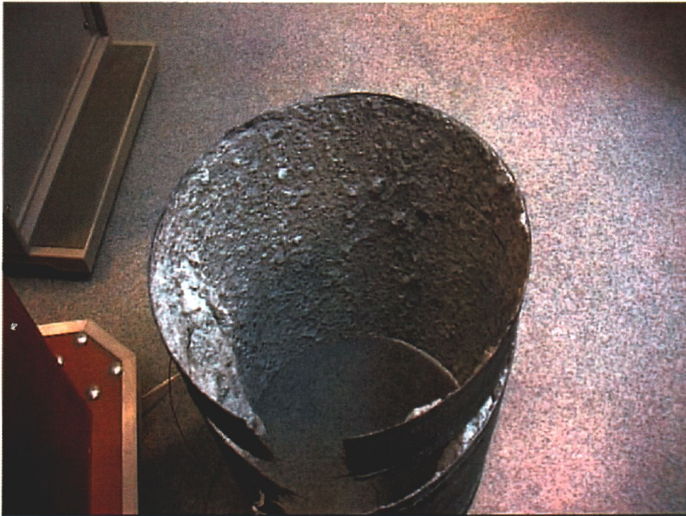
Fig B-5 2-lags fibervev spaltet av fra søyle S4 ved brudd
