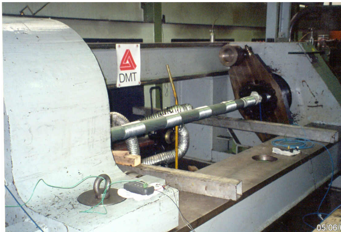
Foto 1. Kabelen montert i utmattingsprøvemaskinen
