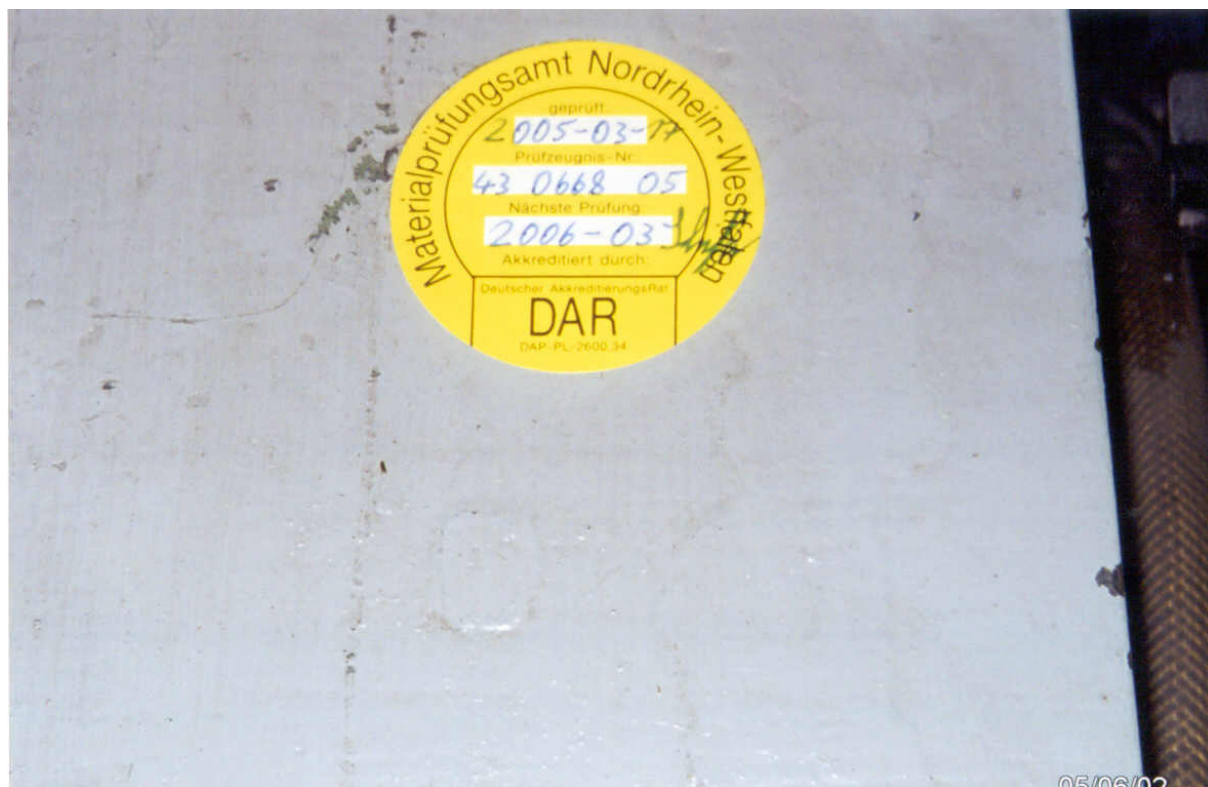
Foto 10. Merke som viser at maskinen er kalibrert.
