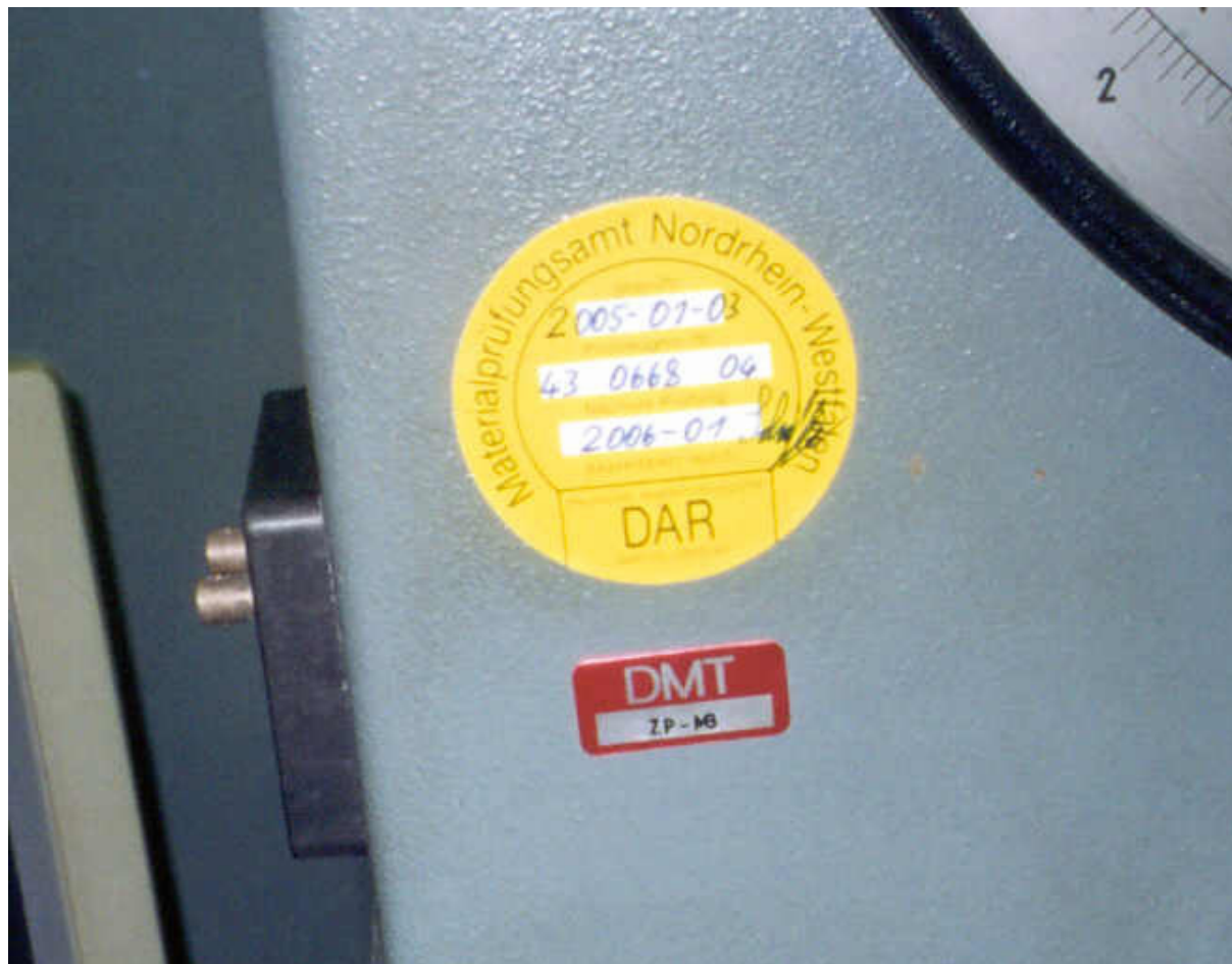
Foto 17. Merke som viser at maskinen er kalibrert.
