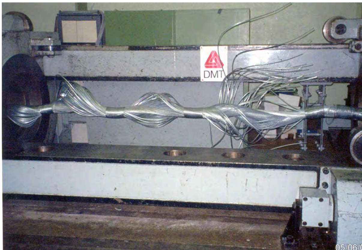
Foto 4. Kabelen er strukket til brudd.
