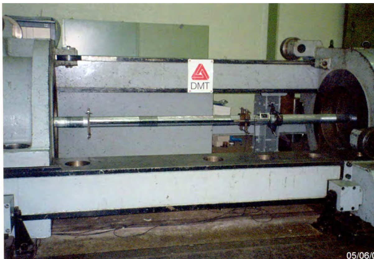
Foto 1: Kabel montert i prøvemaskin
