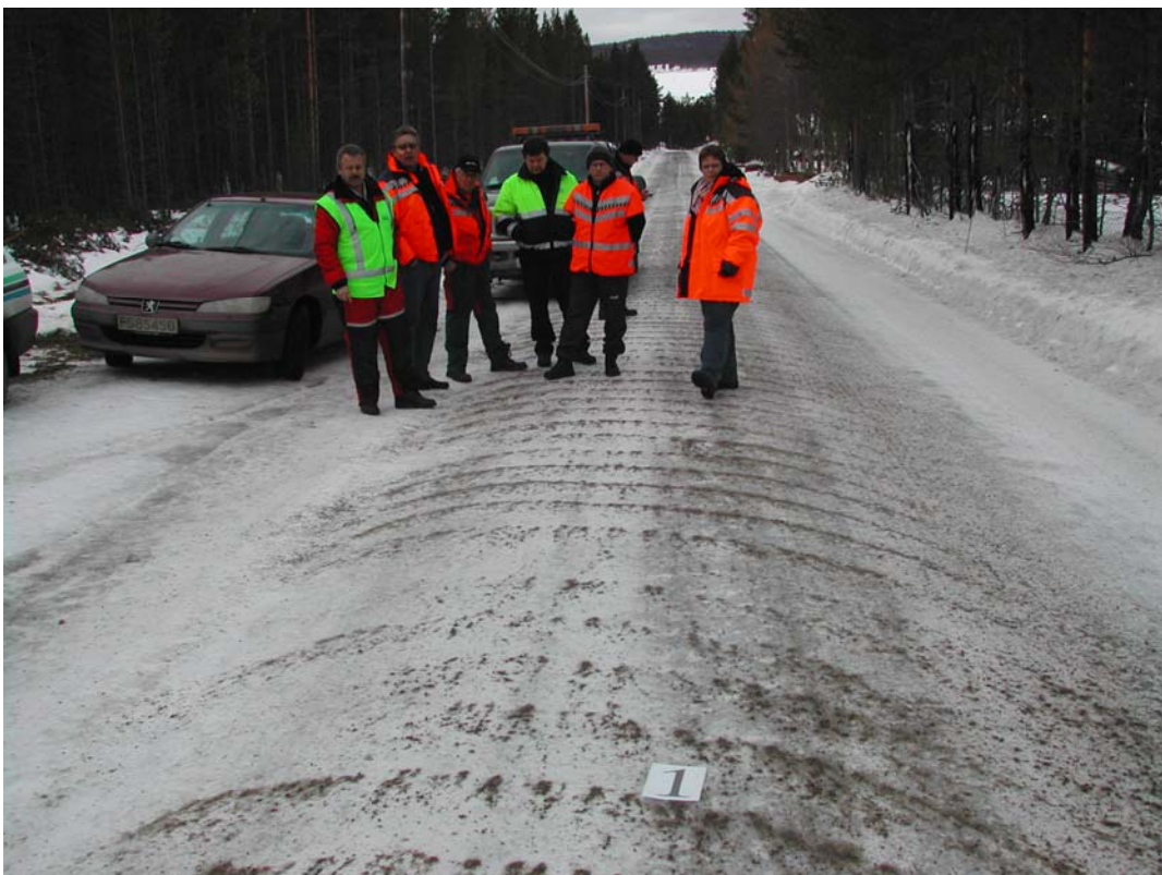
Figur 4.6: Spredemønster etter Stratos Lava med opprinnelig tallerken
