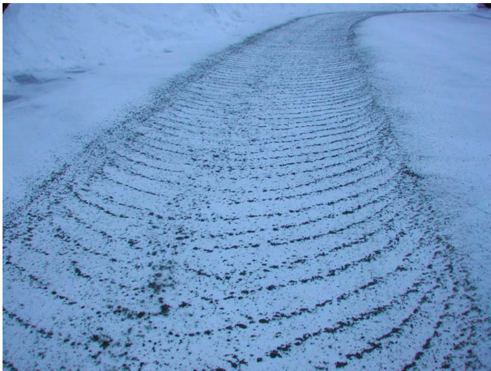
Figur 4.7: Spredemønster etter Stratos Lava med alternativ tallerken
