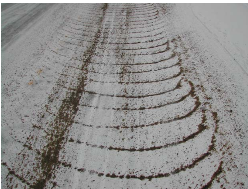
Figur 4.6: Strøbilde etter Tynsetbilen. Innstilt på 2 meter
