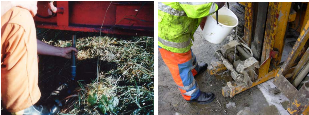
Figur 5.2. Sonde med kondom for å hindre tap av metningsvæske (t.v.). Vannfylling av borhull (t.h.)
