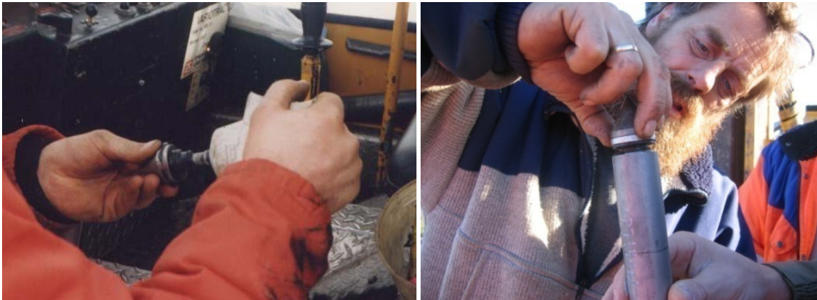
Figur 5.5. Montering av spiss med spaltefilter etter metting med fett. Bildet til venstre viser uheldig innpressingsprosedyre som ble mye benyttet tidligere.
