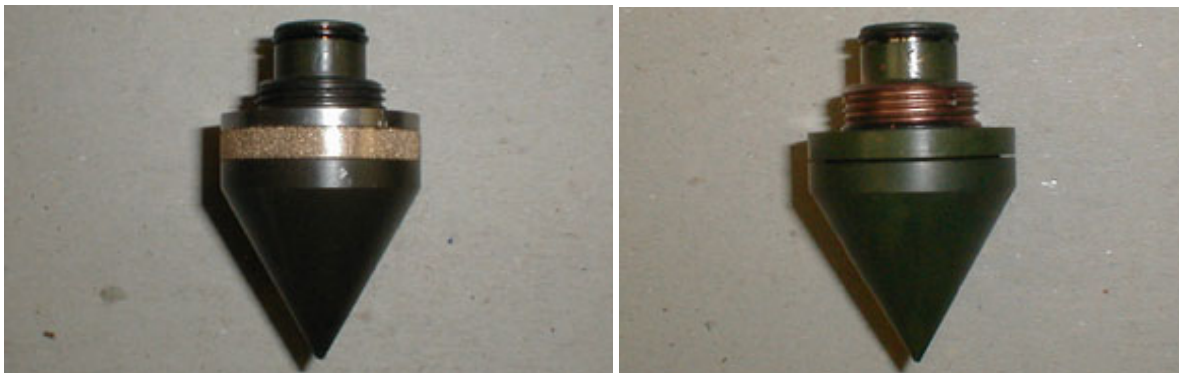
Figur 5.1 Spiss med porøst filter (t.v.) og spaltefilter (t.h.).
