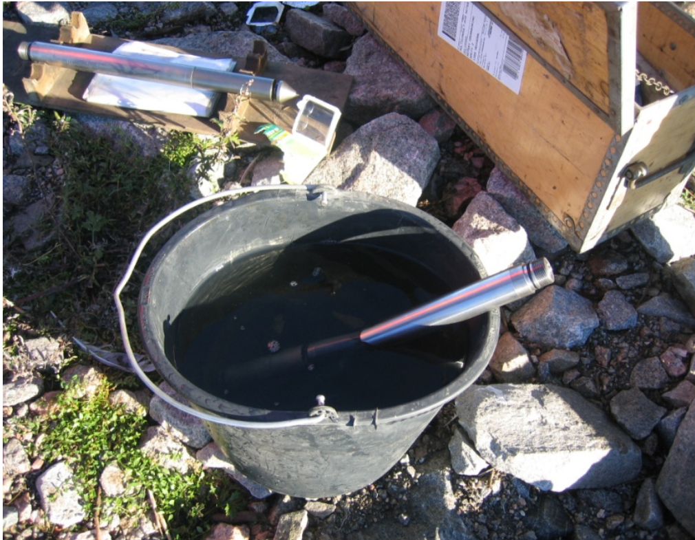
Figur 5.6. Oppbevaring av sonde i temperaturkontrollert vannbad.
