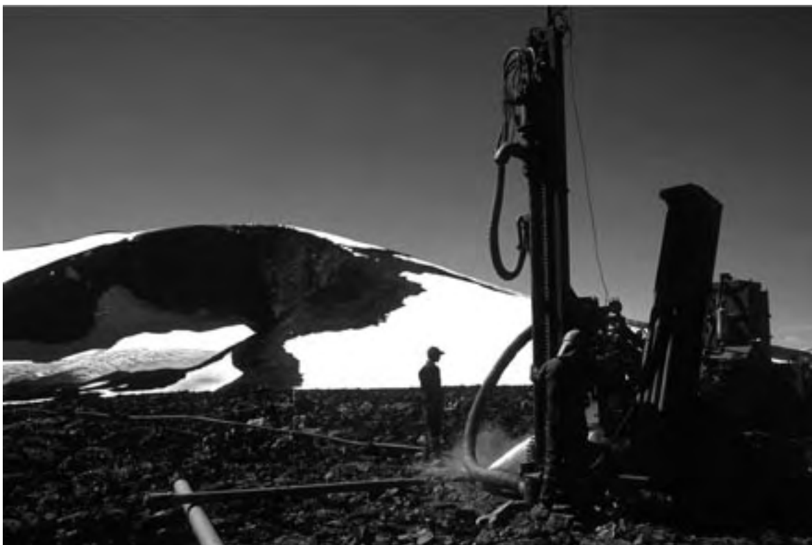
Figur 2: Boring av et 129 meter dypt hull i permafrosten på Juvvasshøe (61°40 '32 ' N, 08°22 '04 ' Ø, 1894 m o.h.) i Jotunheimen, august 1999 (Foto: K. Isaksen).
