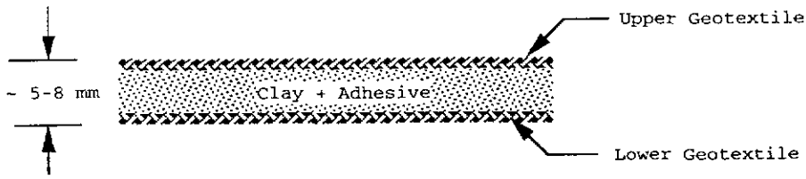
Figur 1. Tørr bentonitt bundet til geotekstil med lim
