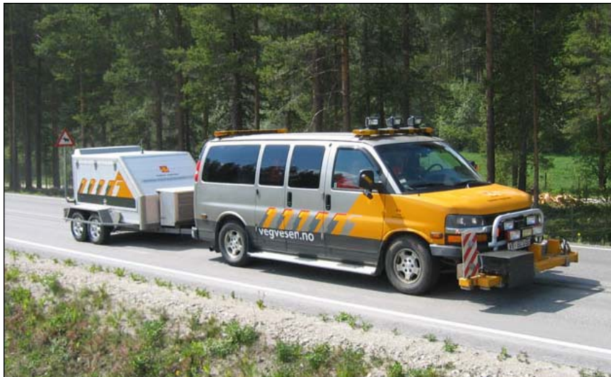
Figur 1 Målebil med utstyret ROAR montert (Opsahl 2006.)
