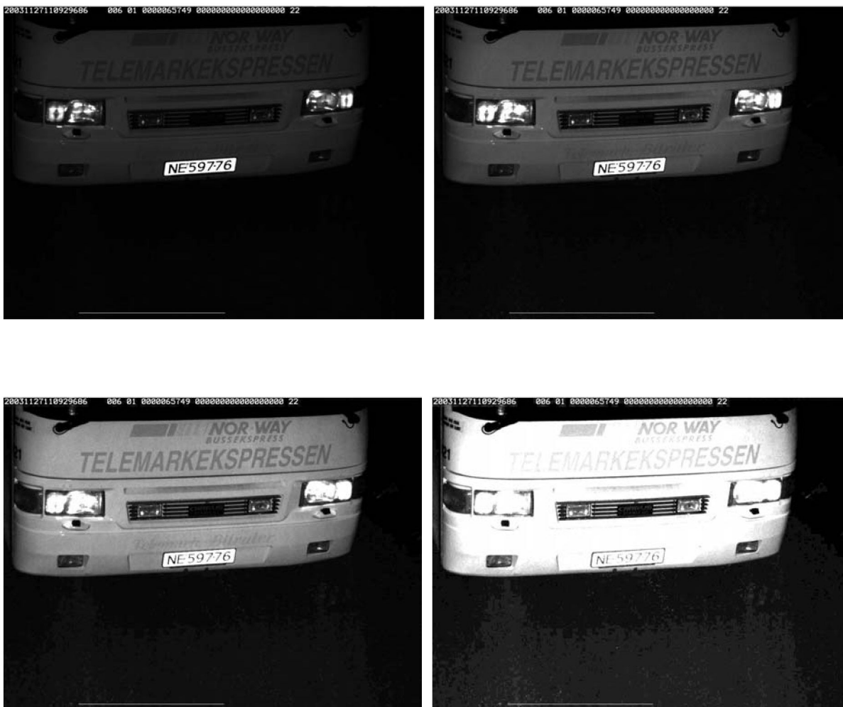
Figur 11.1. Eksempler på bruk av lysstyrke ved gjenkjenning av registreringsnummer og biltype
