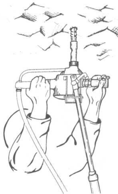
Figur 11 Luftdrill med matekolonne
