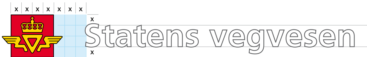
Fasadeskilt med frittstående bokstaver, oppbygning og avstandsprinsipp
