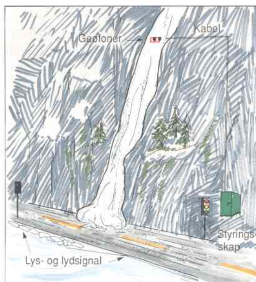
Figur 2.17 Geofoner kan brukes til å registrere skred som er i bevegelse. Trafikantene blir varslet om skredet med lys- og lydsignaler. (Foto: A. Hustad).
