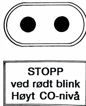
Figur 4.5 Rødt vekselblinkanlegg med underskilt
