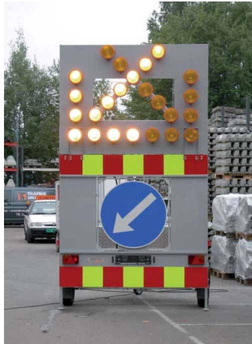
Figur 30 Eksempel på blinkende lyspil på varselpanel
