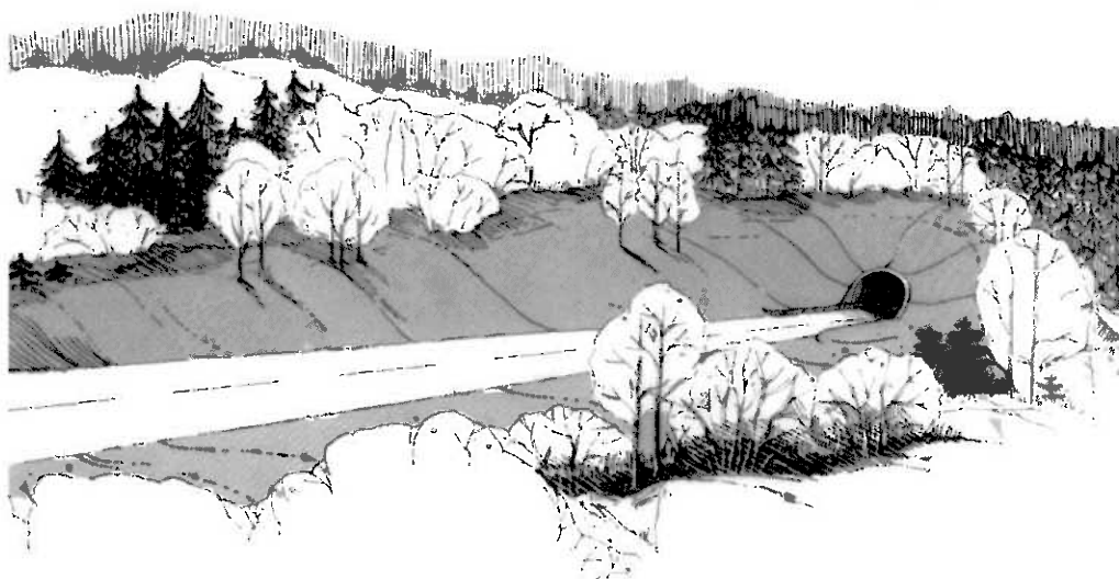
Figur 5.4 Dagsone i terrenng med slak helling. For å unngå sjaktfølelsen ved innkjøringen til tunnelen, er terrenget sterkt bearbeidet. Ill.: Ingeborg Langeland Degnes.
