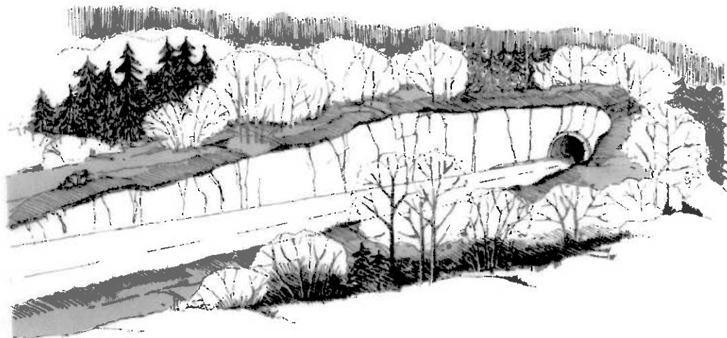
Figur 5.3 Dagsone i terrenng med slak helling. Forskjæringene blir lange og dype, og gir en lite positiv opplevelse av inngangen til tunnelen. Ill.: Ingeborg Langeland Degnes.
