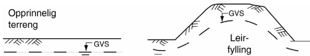
Figur 14.16 Oppfukning av leirfylling.
