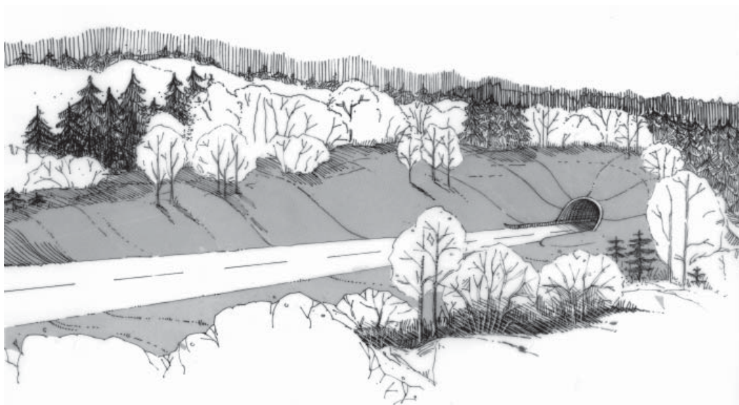
Figur 5.4 Dagsone i terrenget med slak helling. For å unngå sjaktfølelsen ved innkjøringen til tunnelen, er terrenget sterkt bearbeidet. Ill.: Ingeborg Langeland Degnes.
