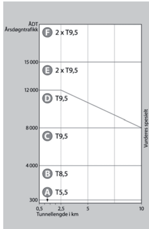
Figur 6.1 Tunnelklasser (tilsvarer figur 4.1)
