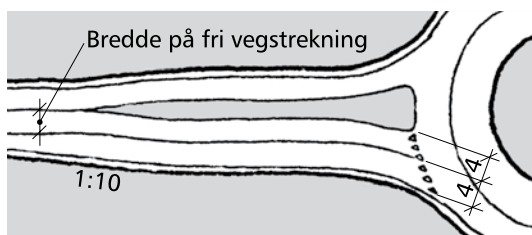
Figur 4.50: Breddeutvidelse fra ett til to kjørefelt på tilfarten (mål i meter)
