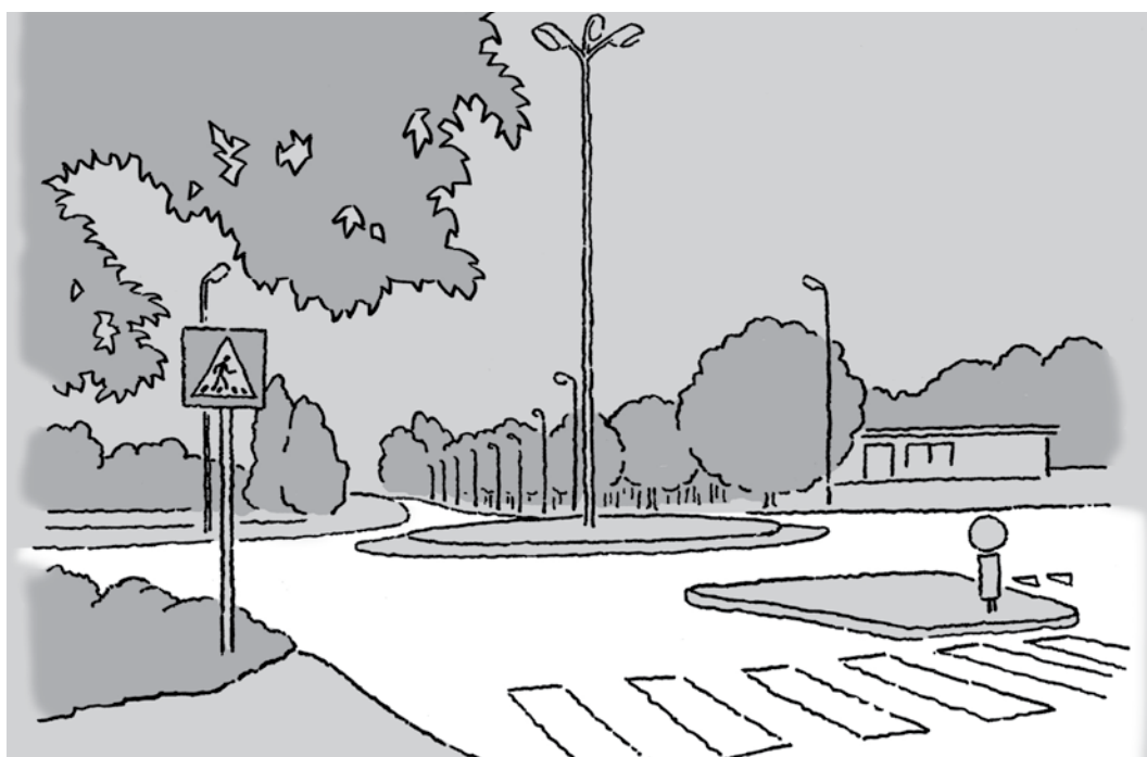
Figur 4.46: Lysmast i sentraløya markerer rundkjøring
