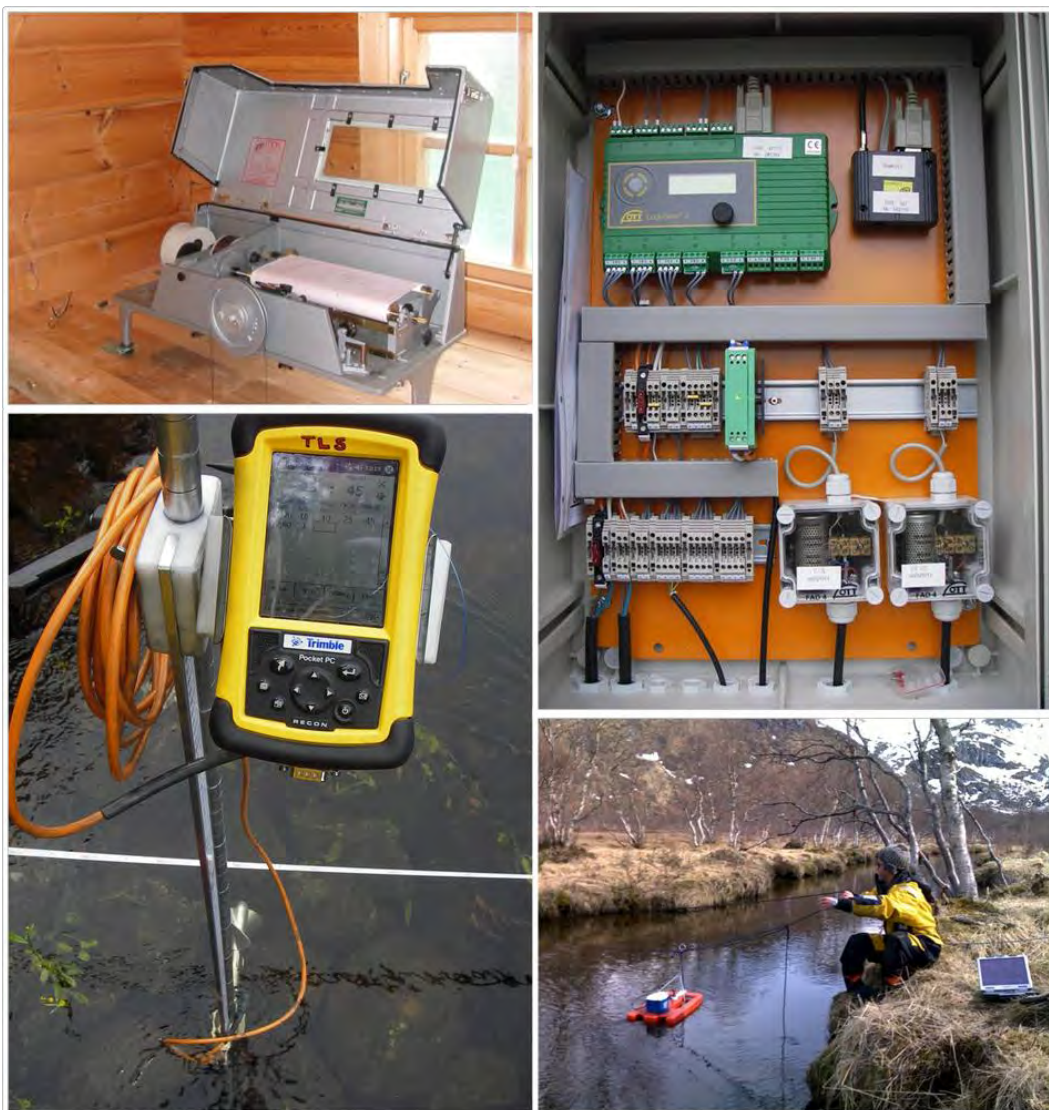
Oppe til venstre: limnigraf. Oppe til høyre: instrumentskap med logger. Nede til venstre: vannføringsmåling med flygel på stang. Nede til høyre: vannføringsmåling med ADCP (Akustisk doppler). (Foto: NVE-HHs stasjonsbilde arkiv).
