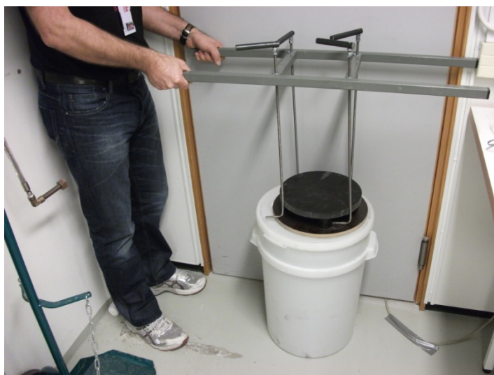
Bilde 12 Løfteinnretning med svingbare armer
