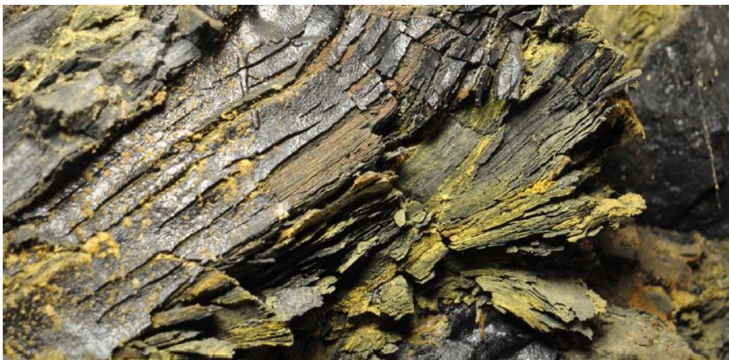
Figur 4: Forvittra alunskifer. På bildet ser ein oppflakinga som gjer alunskiferen ekstra sårbar for forvitring. Høgda på bildeutsnittet er 5 cm. Dei gule punkta er jernsulfat. Kjelde: NGI (Endre 2013).
